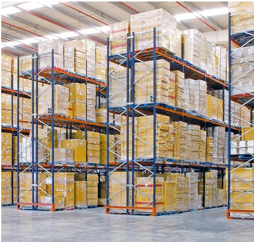
Figura 2: Tramerías para Almacenaje de Carga Paletizada
