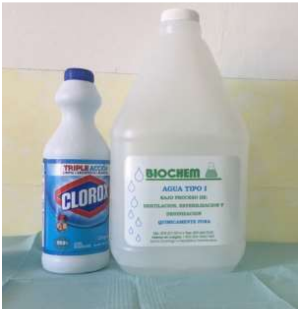
Figura 20. Cloro comercial (clorox) y agua destilada, para obtener la dilución de hipoclorito de sodio 2.5%. Fuente propia del autor
