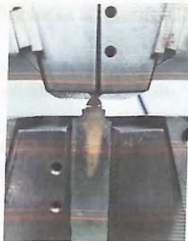
Figura 5. Ensayo de tracción en maquina instrom serie 3369
