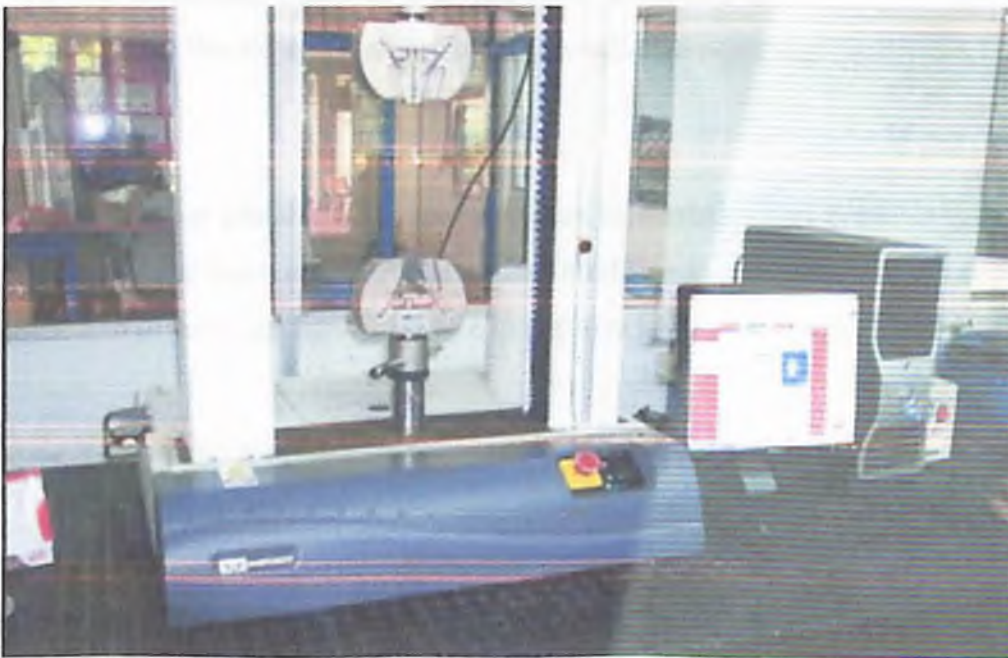
Imagen 5. Máquina universal de ensayos Instron serie 3369 realizando un ensayo de tracción. 49
