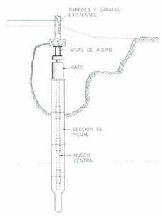
PILOTE SECCIONADO Figura 3.3
