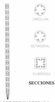
PILOTE PRE-FABRICADO DE HORMIGON Figura 3.2
