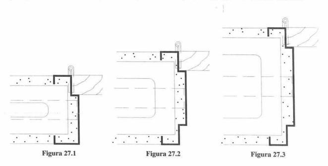
Para darle un poco más de rigidez al marco durante el transporte, los extremos de las patas vienen unidas por un pequeño canal soldado, que se puede eliminar después de colocado el marco, si es que queda sobre el nivel del piso. A cada lado del marco hay tres lengüetas soldadas que sirven de anclas, lo suficientemente flexibles para poderse doblar hasta coincidir con las juntas horizontales de las hiladas.
