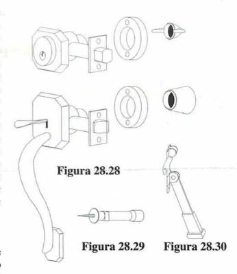
goma atornillados a las paredes o a los pisos, Figura 28.29. Éstos pueden tener aldabitas o resortes de ganchos en "U" de modo que la puerta queda relativamente fija en su máxima apertura, sin cerrarse por la acción del viento. Otro tipo de retén, Figura 28.30, mantiene la puerta abierta en su sitio por la fricción contra el piso por el pie de goma colocado en su parte inferior; para zafarlo se hace girar la pieza entera hacia arriba y se engancha en la ranura de la parte superior.
