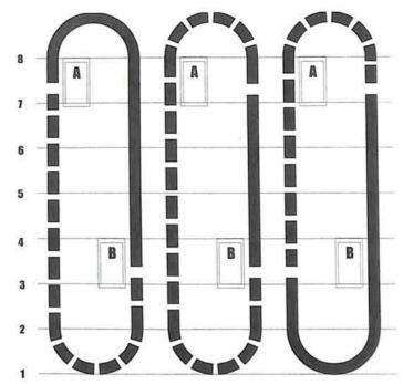
Esquema de Zonificación para Operación Colectiva de dos Ascensores
