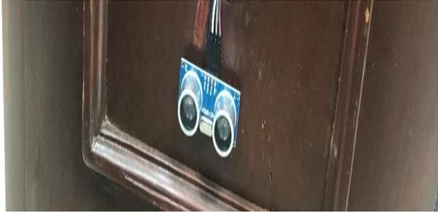
**Ilustración 21.** *Sensores de proximidad*
