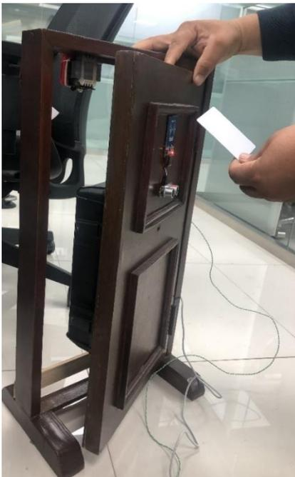
**Paso 6.** Verificar que el Relay corta la corriente al electroimán y se puede abrir la puerta.
