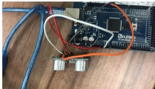
**Ilustración 4 .** *Módulo Ultrasónico o Ultrasonido*
