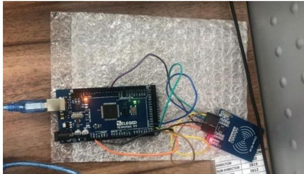
**Ilustración 3.** *Modulo Lector RFID*
