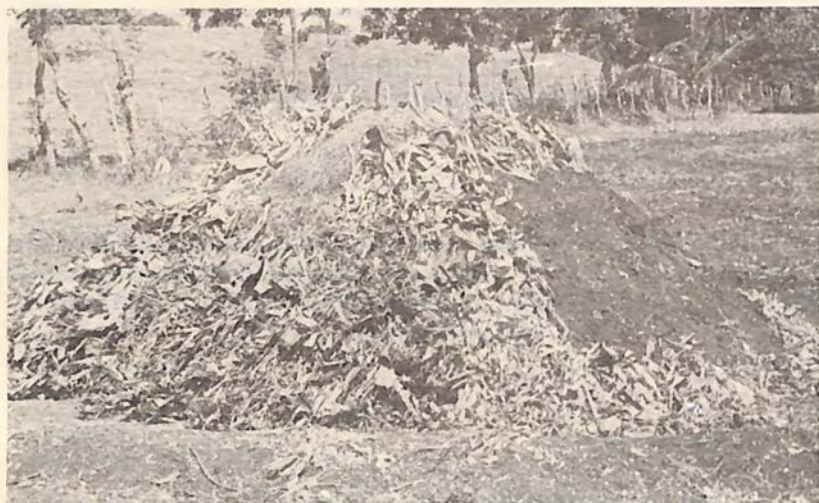
5— Horno tradicional para el proceso de carbonización, no es recomendable en Leucaena por su bajo rendimiento.
