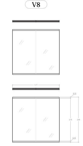
VENTANAL FIJO MATERIAL : ALUMINIO/ VIDRIO DIMENSIONES : 3.95 M X 4.11 M HOJAS: 2
