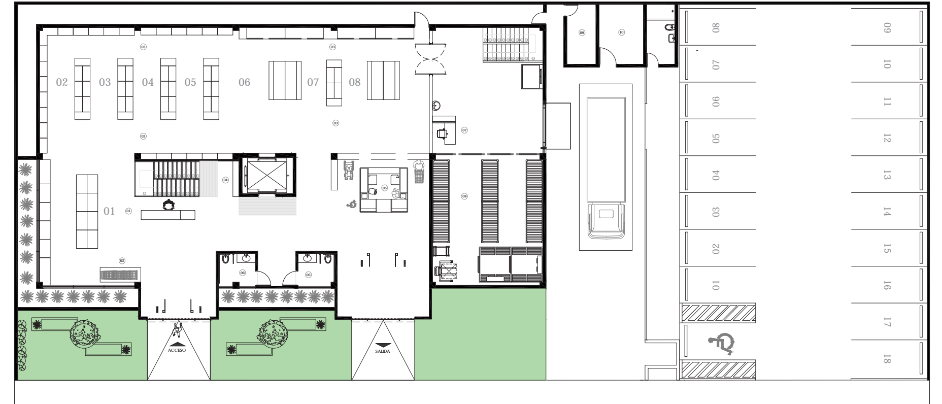
01 PLANTA ARQUITECTÓNICA DE CONJUNTO. 1:250
