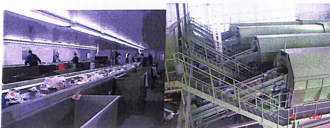
FOTO. 7-2 Líneas de reciclajes y trómeles de una planta de recuperación y reciclaje de los residuos sólidos similar a la propuesta.
