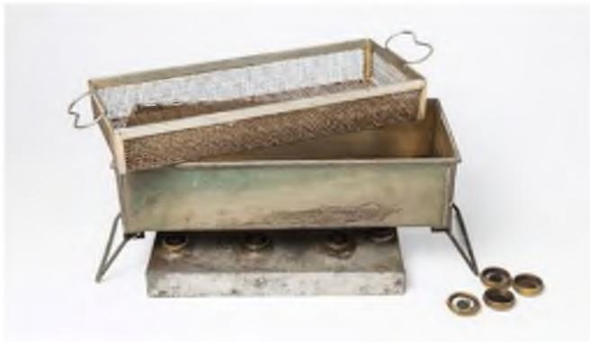
**Figura 7.** Aparato para esterilizar con agua caliente hirviendo por medio de quemadores de aceite, década de 1890.<sup>28</sup>
