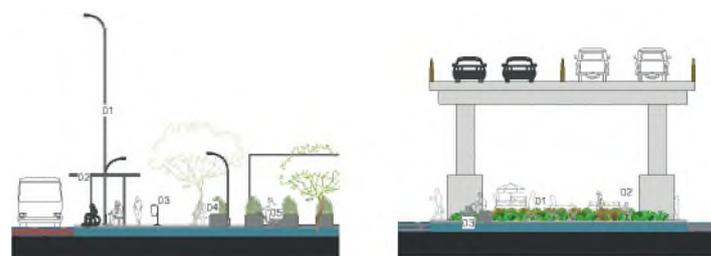
Revitalización de la parte inferior del elevado con cruces amplios y vegetación. Espacios comerciales como conectores y soporte para la estación de metro. Implementación de ciclovía para conectar usuarios del metro al ensanche. Mejora integral para una intersección más funcional.
