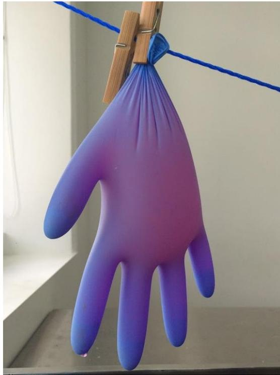
Fig. 9. Muestra a la que se le aplicó el test de filtración con eritrosina. Se observa una gota en el dedo índice que indica que permeó. Fuente: propia del autor.
