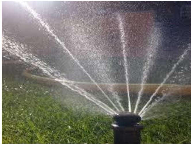
Figura 5 Aspersor rotativo turbina. Fuente: (Habitissimo, 2017)
