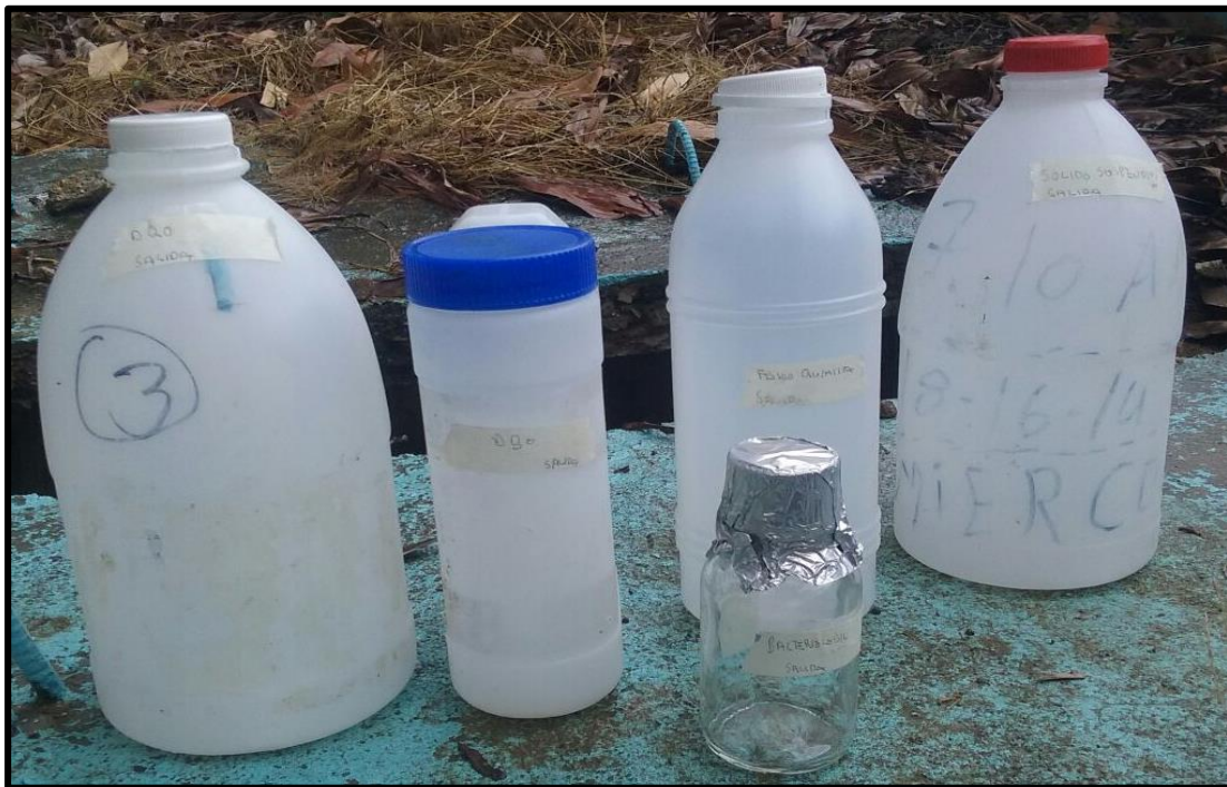
Figura 7: Envases utilizados para toma de muestra de Aguas Residuales. Fuente: Planta de Tratamiento de Aguas Residuales, Constanza, Propia, 2016.
