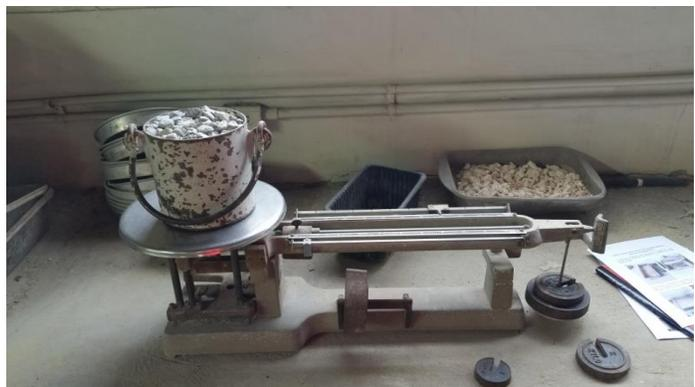
ILUSTRACIÓN 6: ENSAYO DE PESO UNITARIO PARA AGREGADO GRUESO ASTM C-29, FUENTE PROPIA.
