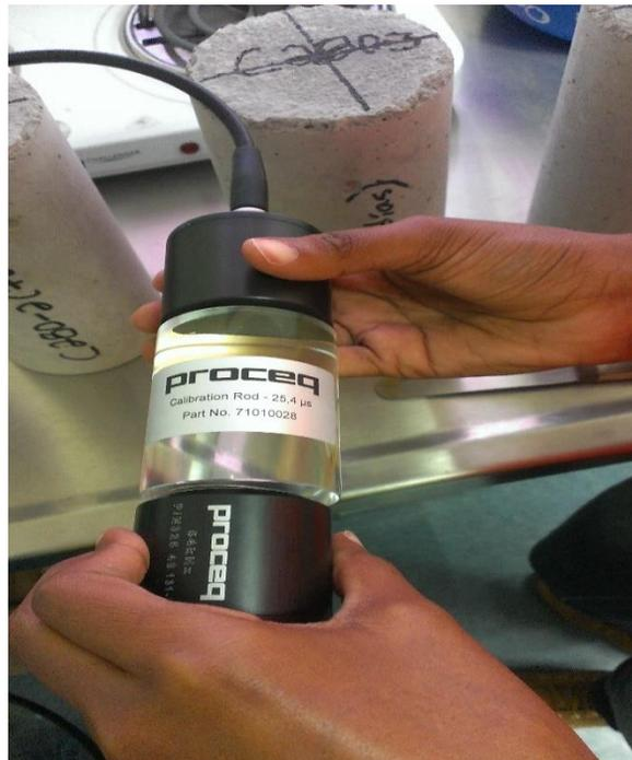
**ILUSTRACIÓN 26: CALIBRACIÓN DEL TIEMPO DE PROPAGACIÓN DE PULSO EN BASE A REFERENCIA GRABADA EN LA BARRA CALIBRADORA, FUENTE PROPIA.**
