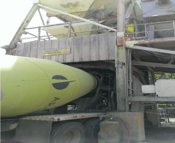
**ILUSTRACIÓN 12: OBTENCIÓN DEL CONCRETO MEDIANTE EL BACIPLAN, FUENTE PROPIA.**
