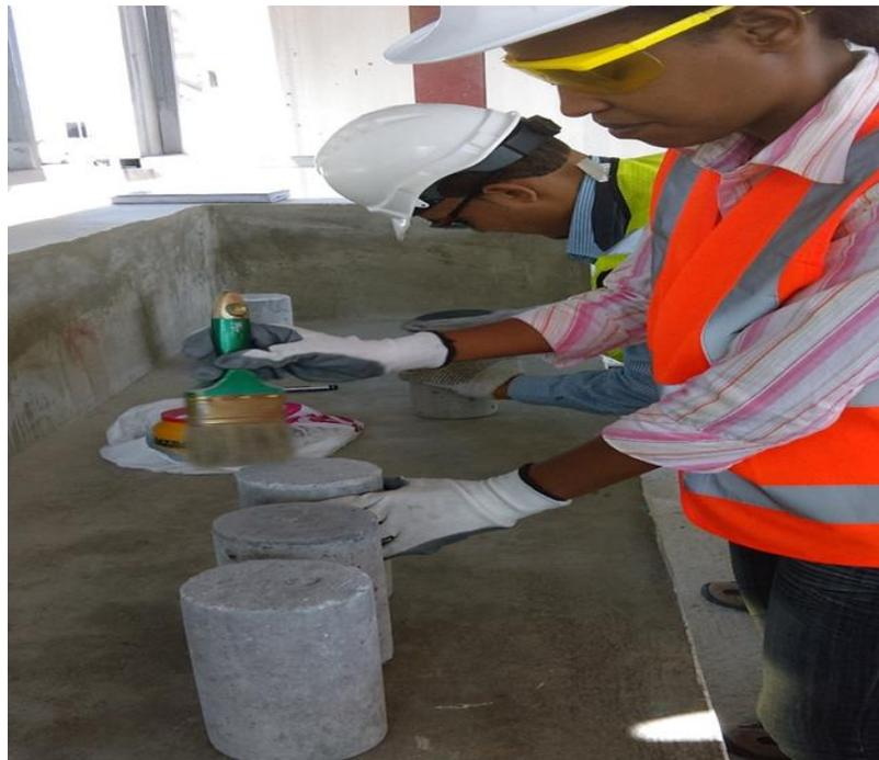
**ILUSTRACIÓN 1: LIMPIEZA DE LAS SUPERFICIES DE CONTACTO EN LA PROBETA, FUENTE PROPIA.**
