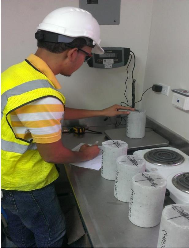
**ILUSTRACIÓN: ENSAYO DE RESISTENCIA A COMPRESIÓN, FUENTE PROPIA.**
