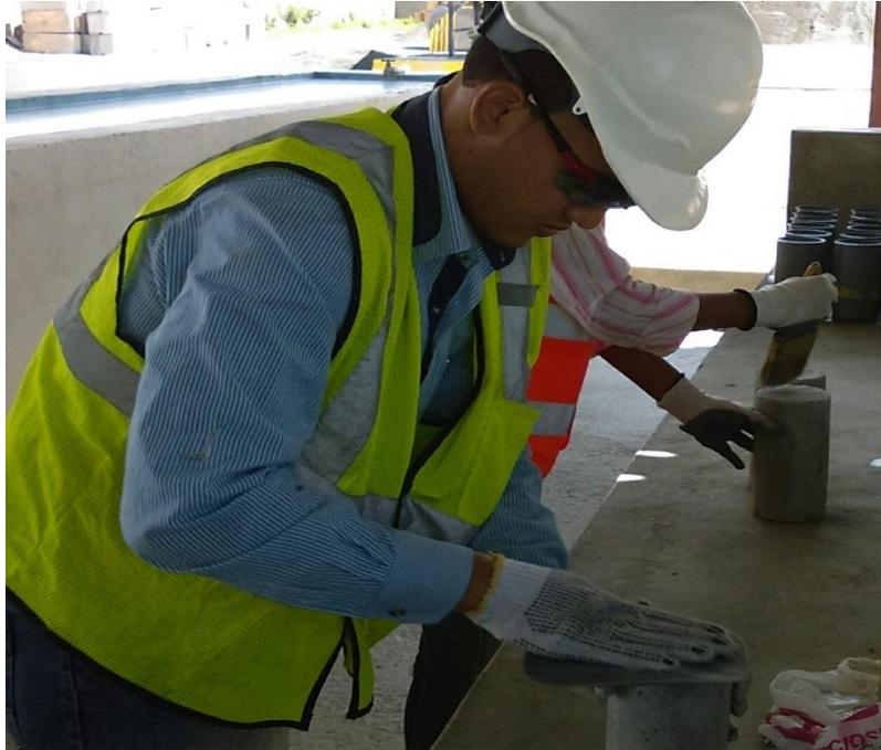
**LUSTRACIÓN 23: LIJADO Y NIVELACIÓN DE LAS SUPERFICIES DE CONTACTO EN LA PROBETA, FUENTE PROPIA.**
