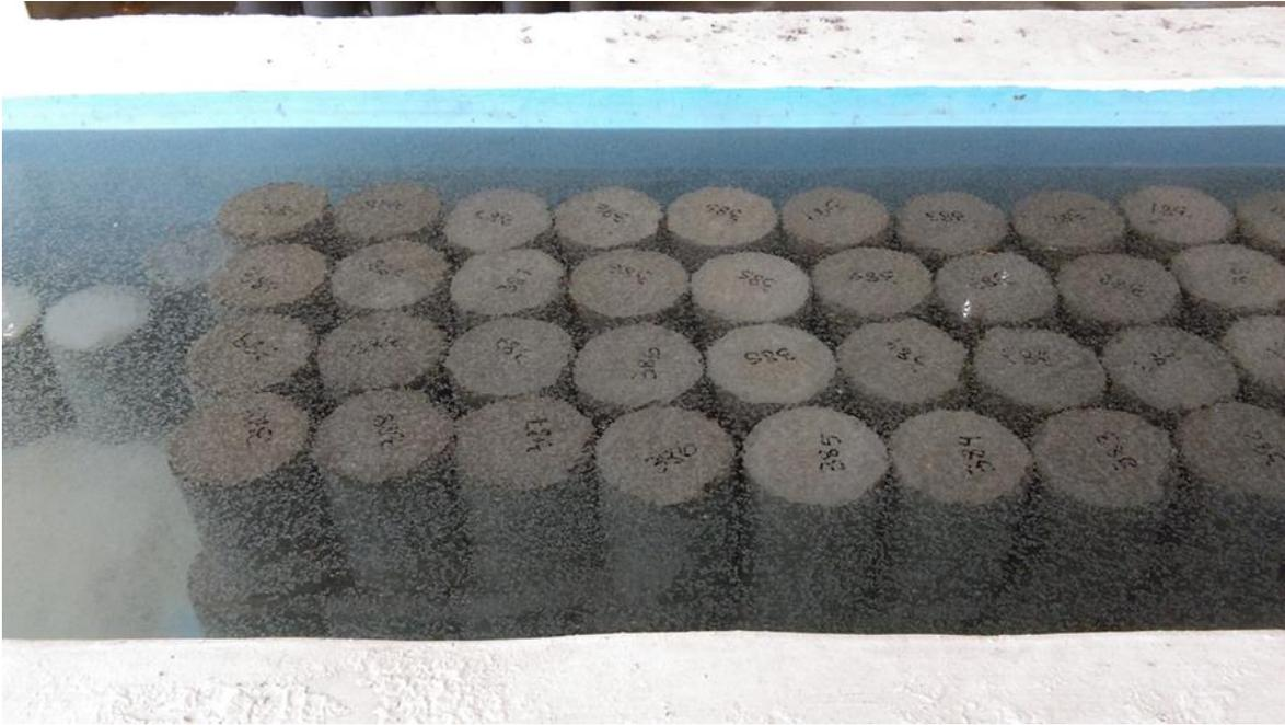
**ILUSTRACIÓN 18:** PROBETAS INTRODUCIDAS EN LA CÁMARA DE CURADO, FUENTE PROPIA.
