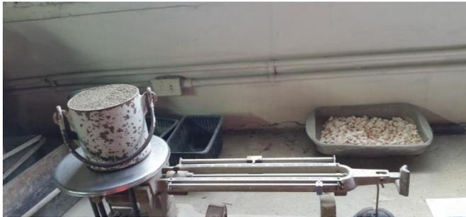
ILUSTRACIÓN 5: ENSAYO DE PESO UNITARIO PARA AGREGADO FINO ASTM C-29, FUENTE PROPIA.
