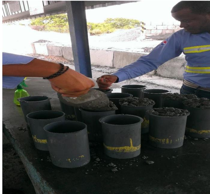
**ILUSTRACIÓN 15: ELABORACIÓN PROBETAS DE HORMIGÓN, FUENTE PROPIA.**
