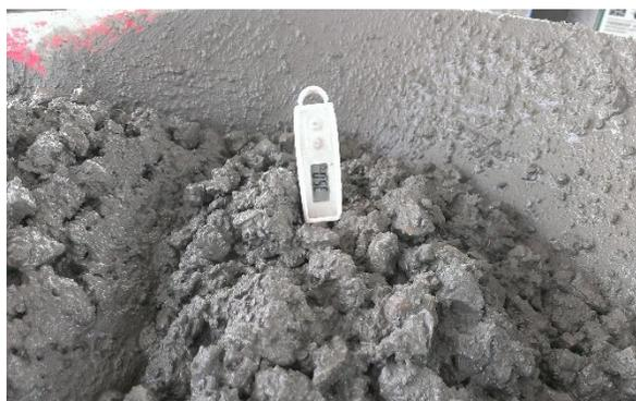
**ILUSTRACIÓN 13: PRUEBA DE TEMPERATURA, FUENTE PROPIA.**
