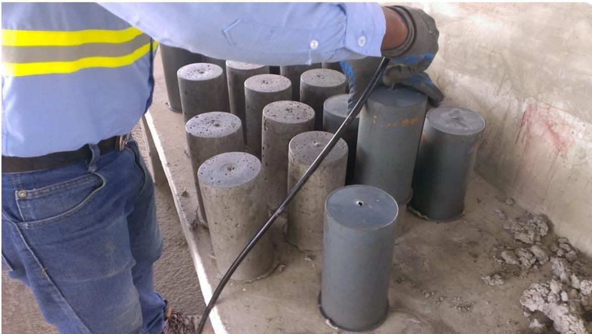
**ILUSTRACIÓN 16: EXTRACCIÓN DE PROBETAS DE LOS CILINDROS MEDIANTE LA MÁQUINA DE COMPRESIÓN DE AIRE, FUENTE PROPIA.**
