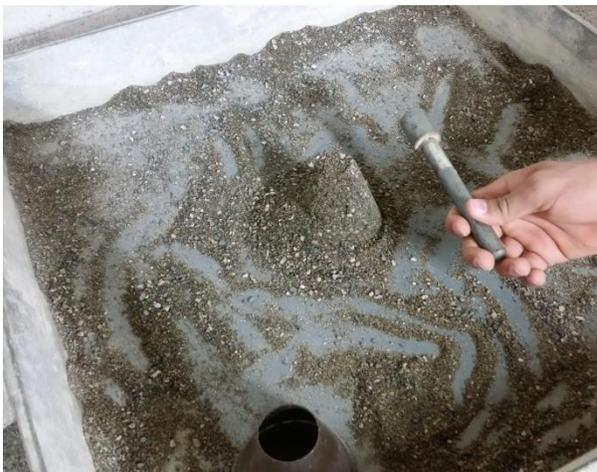
ILUSTRACIÓN 7: ENSAYO DE GRAVEDAD ESPECÍFICA PARA A. F. ASTM 128, FUENTE PROPIA
