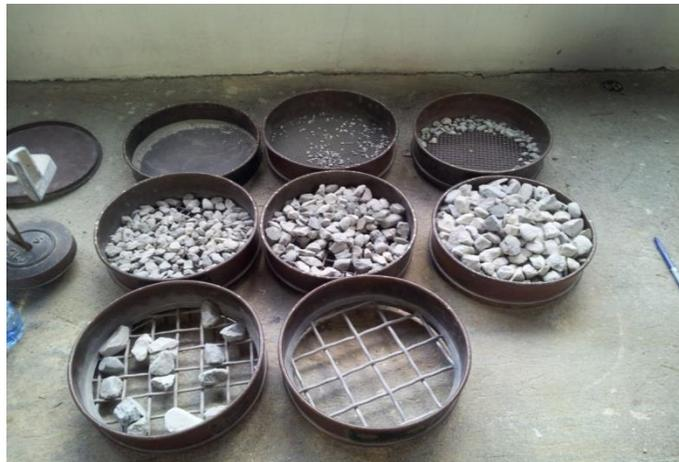
ILUSTRACIÓN 10: ANÁLISIS GRANULOMÉTRICO A.G. ASTM C-136, FUENTE PROPIA.
