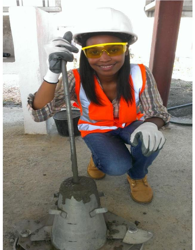
**ILUSTRACIÓN: MEDICIÓN DE FLUIDEZ DEL CONCRETO, FUENTE PROPIA.**
