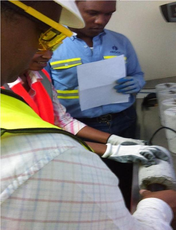
**ILUSTRACIÓN: COLOCACIÓN DE ACOPLANTE, FUENTE PROPIA.**
