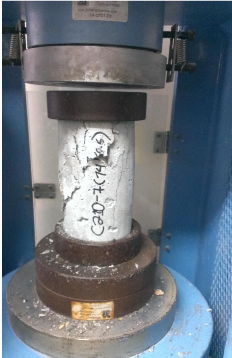
ILUSTRACIÓN 28: ENSAYO DE RESISTENCIA A COMPRESIÓN, FUENTE PROPIA.
