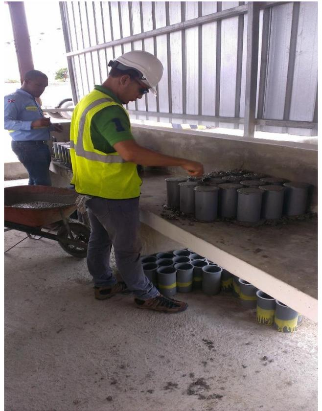
**ILUSTRACIÓN: PRUEBA PESO VOLUMÉTRICO, FUENTE PROPIA.**
