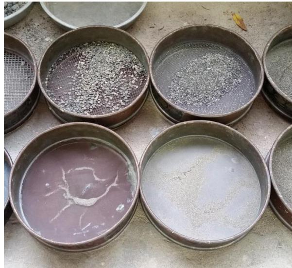
ILUSTRACIÓN 9: ANÁLISIS GRANULOMÉTRICO A.F. ASTM C-136, FUENTE PROPIA.
