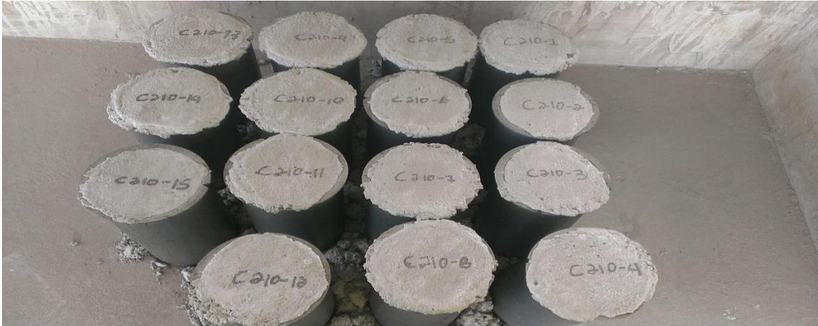
**ILUSTRACIÓN 17: ESPECÍMENES A LAS 24 HORAS, FUENTE PROPIA.**
