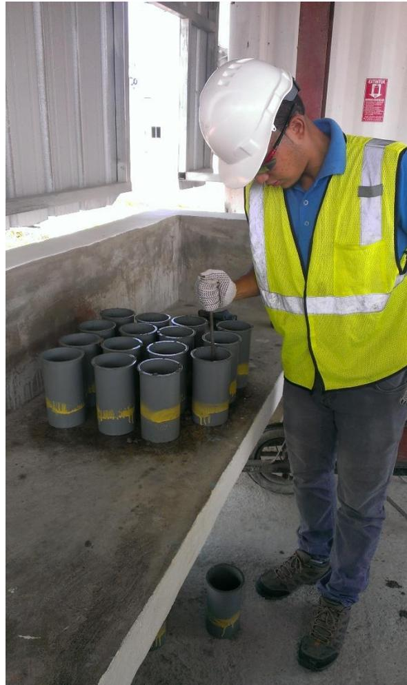
**ILUSTRACIÓN: EXTRACCIÓN DE PROBETAS DE LOS MOLDES, FUENTE PROPIA.**
