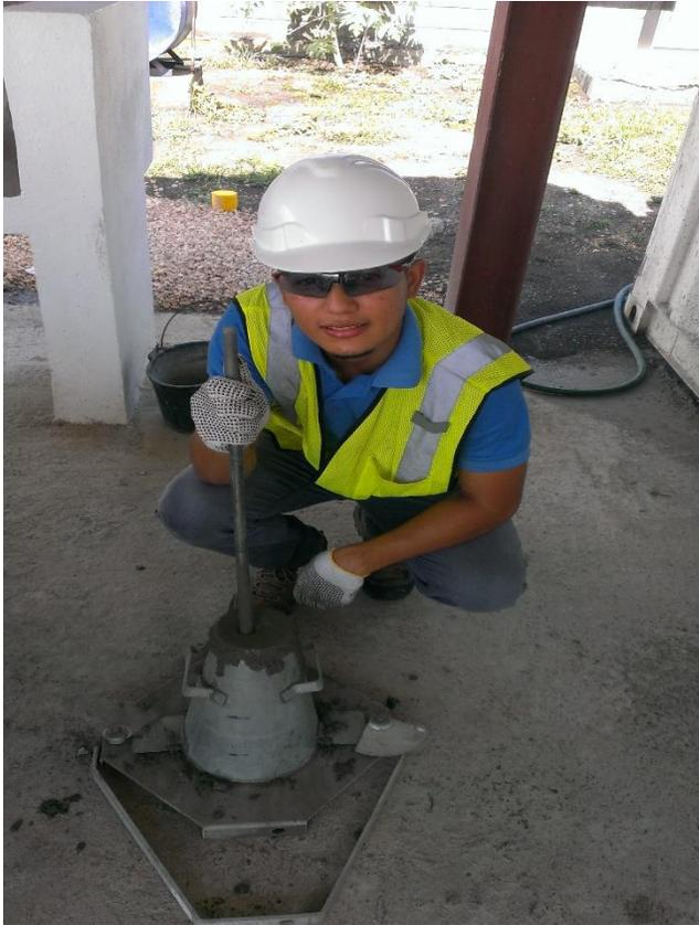
**ILUSTRACIÓN: PRUEBA DE SLUMP, FUENTE PROPIA.**
