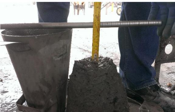
**ILUSTRACIÓN 14: PRUEBA DE REVENIMIENTO O SLUMP, FUENTE PROPIA.**
