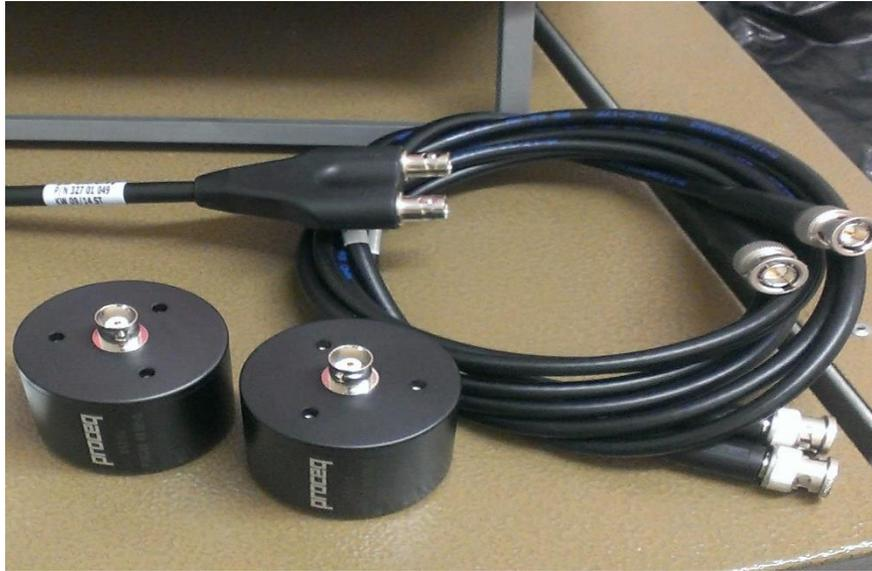
**ILUSTRACIÓN 20: CABLES DE CONEXIÓN CON SUS TRANSDUCTORES (EMISOR Y RECEPTOR), FUENTE PROPIA.**
