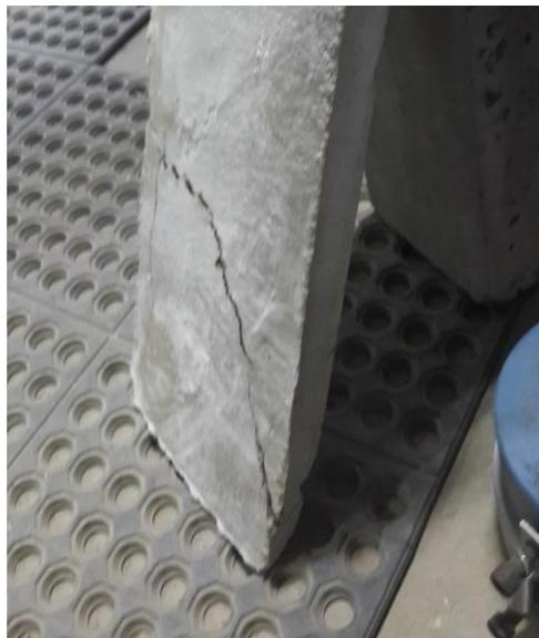
Figura 20: Representación de rotura para viga de ferrocemento
