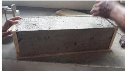
Figura 10: Desencofrado para viga de hormigón armado
