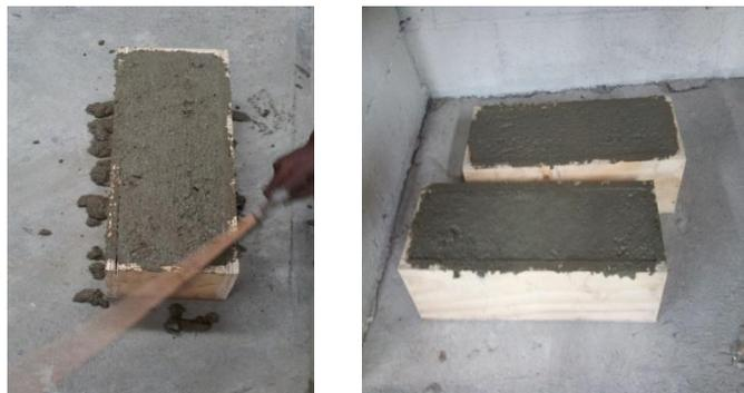
Figura 9: Acabado final para viga de hormigón armado
