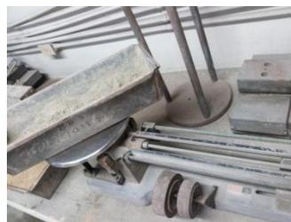
Figura 11: Medida en la balanza de los agregados para viga de ferrocemento
