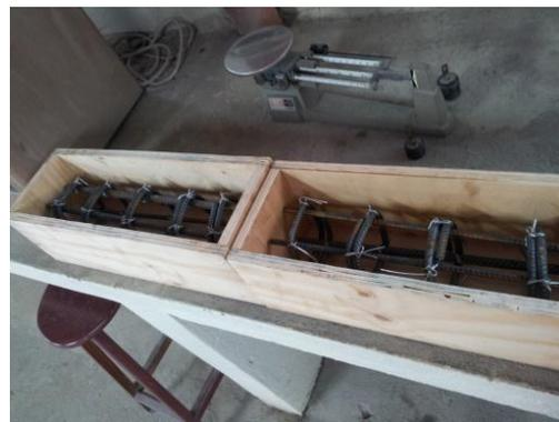
Figura 6: Montaje de la armadura interna en el encofrado para viga de hormigón armado
