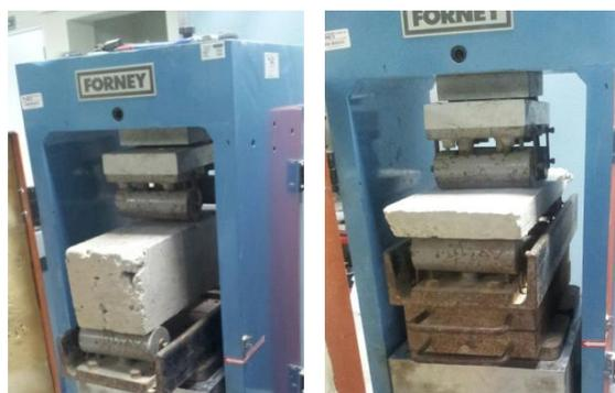
Figura 18: Introducción de vigas en máquina para flexión
