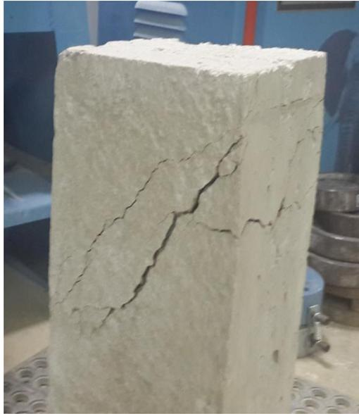
Figura 19: Representación de rotura para viga de hormigón armado
