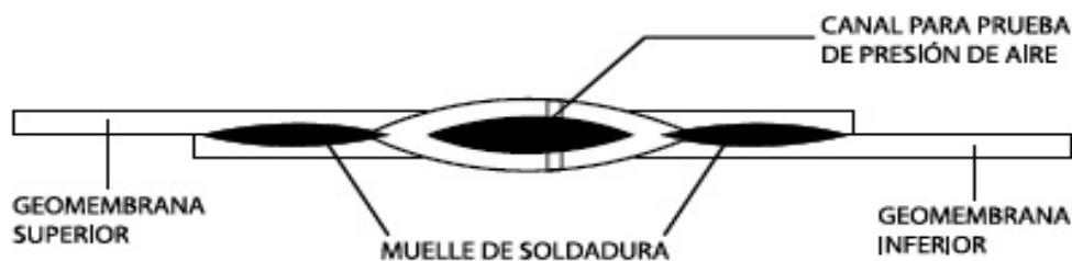
Ilustración 35. Sellado por fusión. (Amanco Geosinteticos, 2010)
