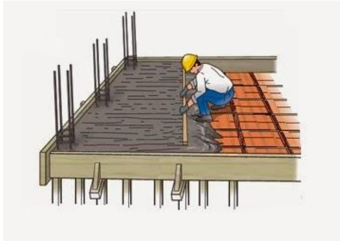
Ilustración 1-0-1- Esquematación de Losa Maciza (Maldonado)
