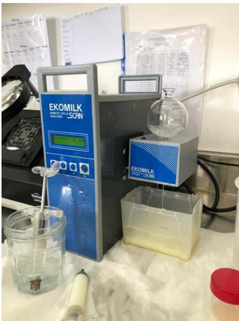
Figura 14. Maquina EKOMILK en proceso de análisis del Recuento de Células Somáticas.
