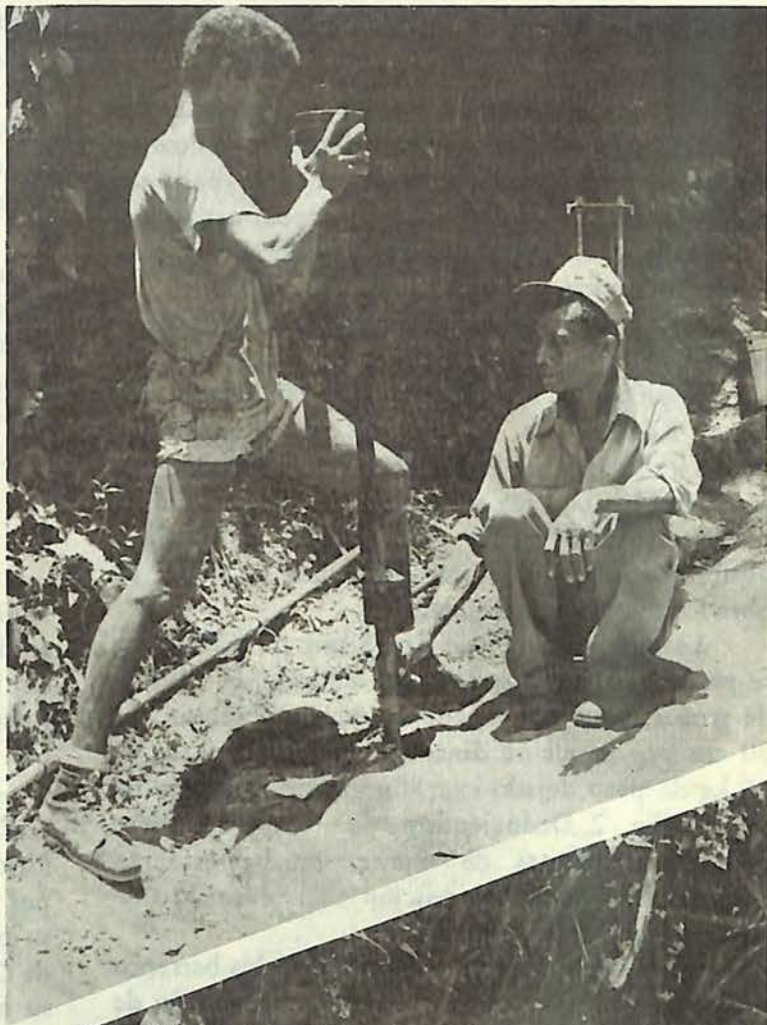
Fig. 2. Penetración dinámica del tubo de pared delgada, Palo Quemado.
