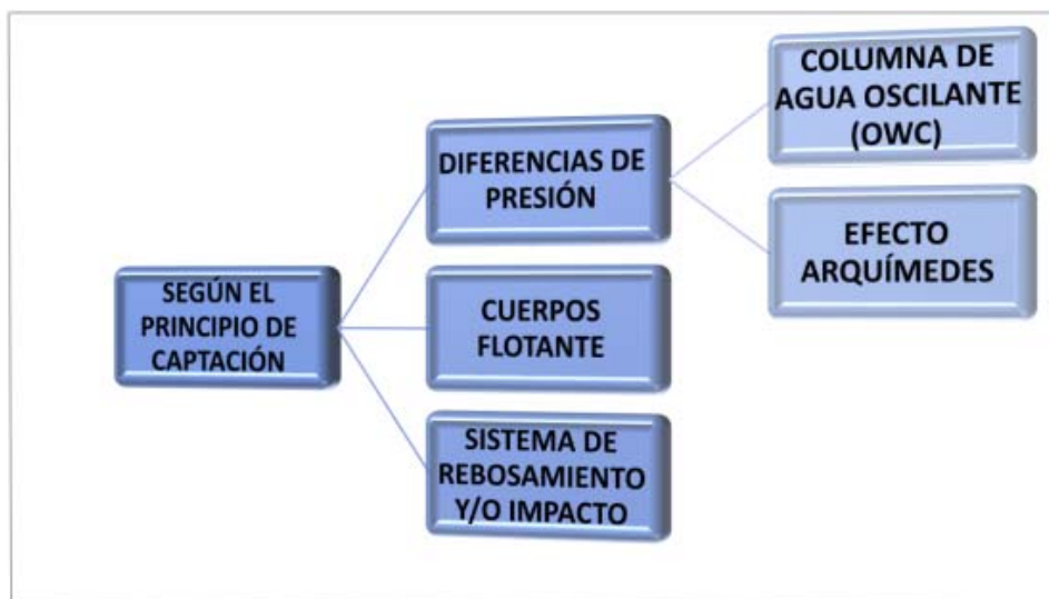
Figura 2.15: Clasificación de captadores de energía de las olas según su principio de captación de energía
