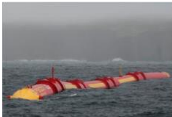
Figura 5. Pelamis P2 desarrollado y probado en UK. Potencia nominal 0,75MW.
