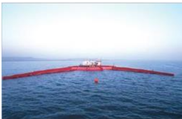
Figura 6. Wave Dragon desarrollado y probado en Dinamarca. Potencia nominal 11MW
