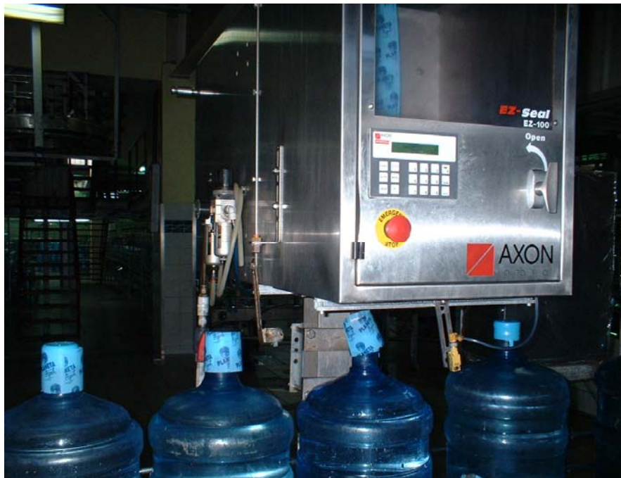
B8: Colocación de Codificación y Bandas de Seguridad
