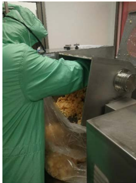
Figura 4. Descarga de viruta para siguiente proceso.
