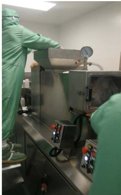
Figura 5. Alimentación de viruta a la extrusora en la cámara 1.
