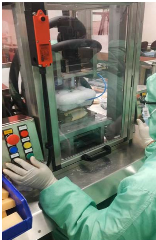
Figura 12. Operador troquelando la barra de jabón.
