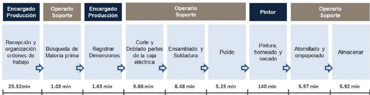
Ilustración 7. Proceso confección caja eléctrica
