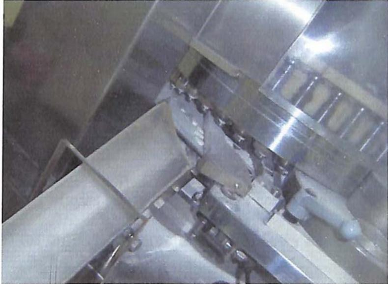
Antes de los comprimidos salir del proceso, pasan por una Tablet Deduster o “Máquina Limpiadora de Comprimidos”, ya que en la superficie de los comprimidos se queda una cantidad de polvo o materia prima que afectan la calidad del producto.
