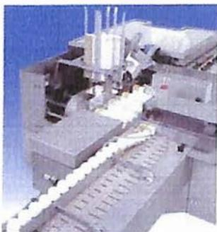
El dispositivo para conexión en línea asegura el estuchado de productos con formas irregulares con igual desempeño.
