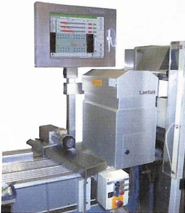
El instante en que se realiza la exploración del control óptico de llenado se determina en el menú “Parametrización” por medio del valor de entrada “Trigger”. Este corresponde al tramo en mm. comprendido entre la posición del envase en la posición cero de la máquina y la posición que tiene al estar directamente debajo de la cámara.
