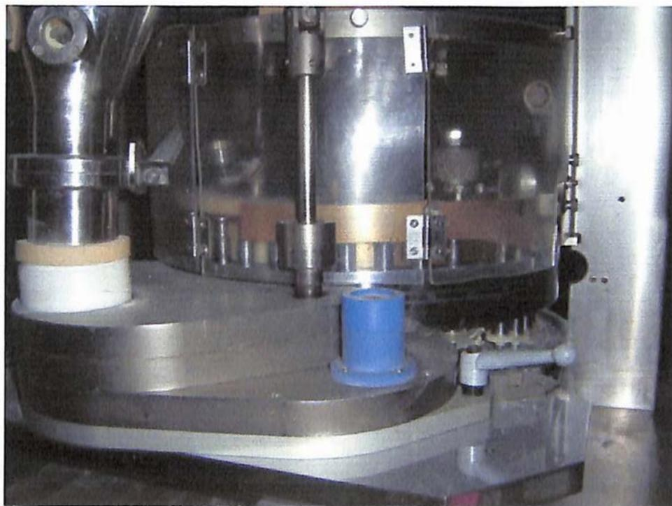
Una vez que la materia prima se encuentra dentro de las matrices del disco giratorio se hacen pasar por una estación de Pre-Pressure o “Pre-Compactación” la cual consiste en darle al comprimido una dureza aproximada a la deseada. Esto es posible gracias a la presión que ejercen dos ruedas de presión (una superior y otra inferior) a los punzones superiores e inferiores cada vez que pasan por esta estación.
