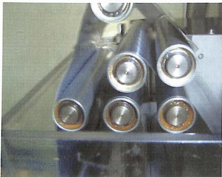
Esto es necesario cuando la impresión está en la cara inferior de la lámina de sellado. En este caso la bobina de lámina de sellado debe ser girada de 180° para montarla sobre su eje receptor.
