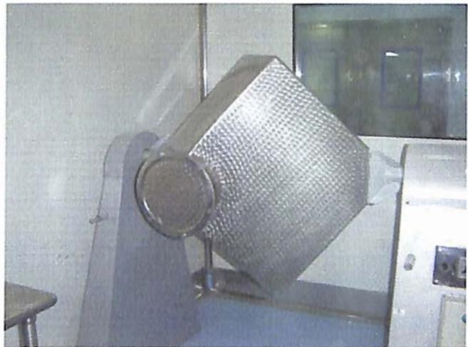
de mezclado es la misma para todos los productos, sin importar sus propiedades, ya que los Mezcladores no cuentan con Temporizadores ni Variadores de velocidad para asegurar que el proceso de mezclado se realice bajo los parámetros de acuerdo a las propiedades de la materia prima y asegurar una Homogeneidad.
