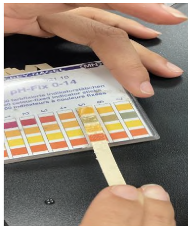
Figura 12. (A) Preparación de muestras para medición pH (B) identificación pH muestra (C) Resultados pH de muestras por triplicado
