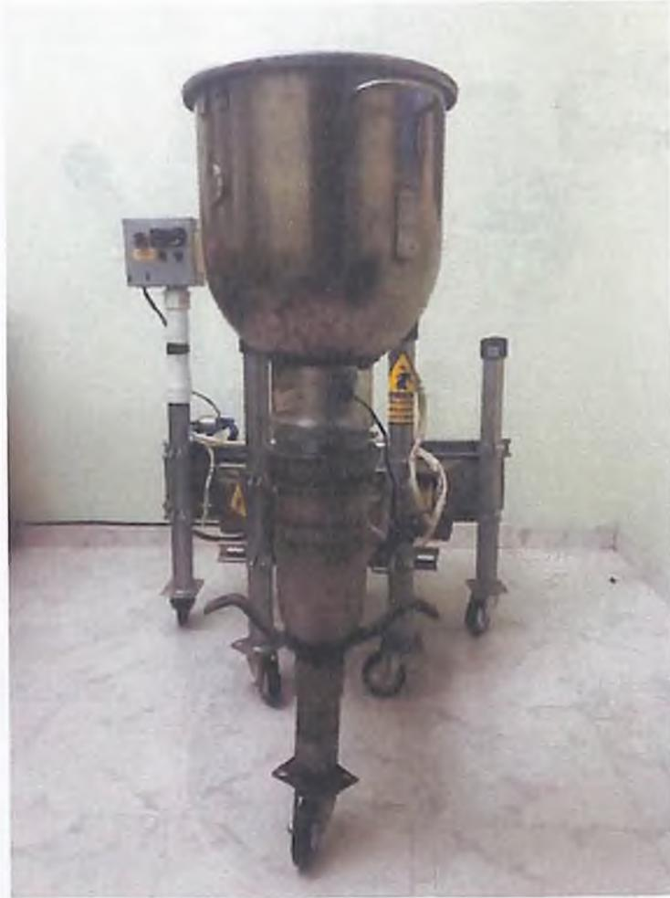
**Fig. 14. Vista frontal del prototipo de secador de lecho fluidizado**
