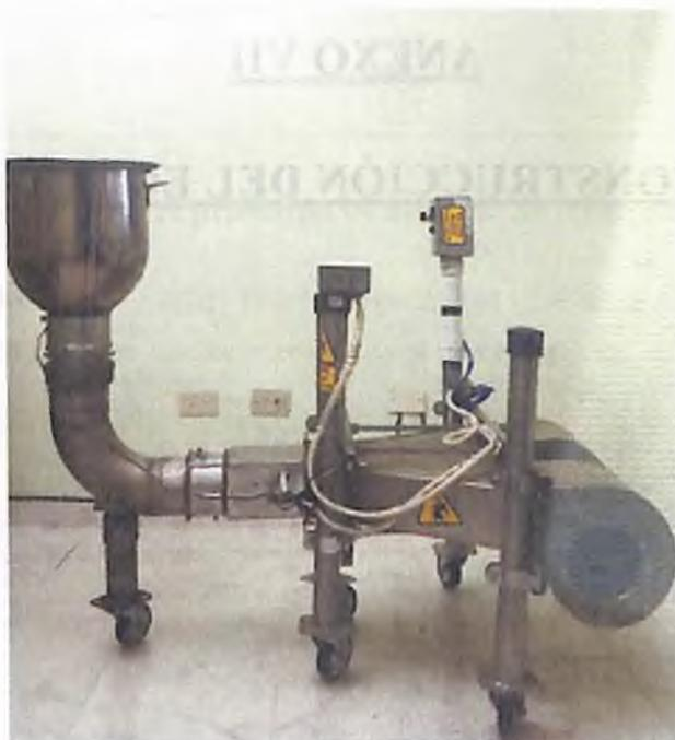
**Fig. 12. Vista lateral del prototipo de secador de lecho fluidizado**
