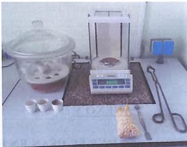
**Fig. 1. Materiales para la determinación de humedad del maíz**
