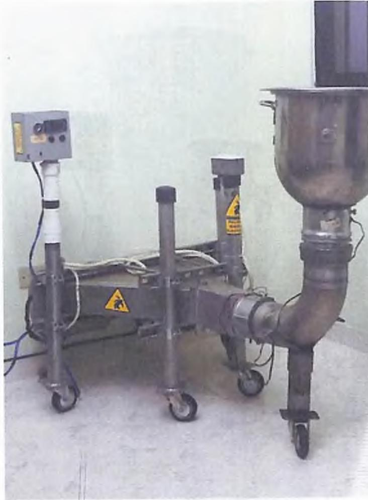
**Fig. 16. Perspectiva del prototipo de secador de lecho fluidizado**
