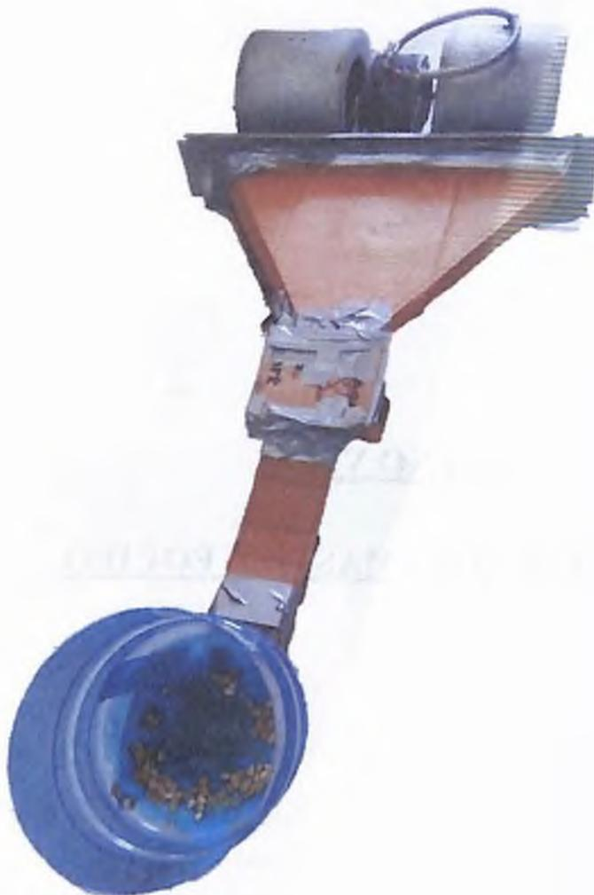
**Fig. 7. Prototipo en cartón del secador de lecho fluidizado**
