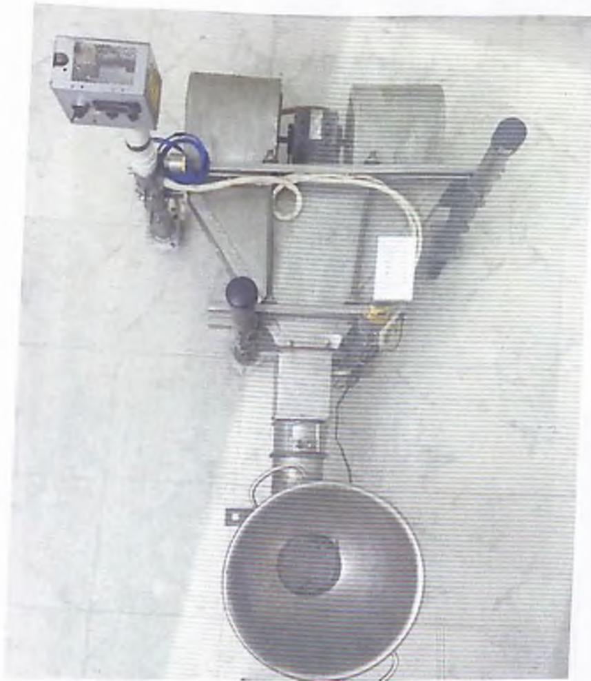
**Fig. 13. Vista superior del prototipo de secador de lecho fluidizado**
