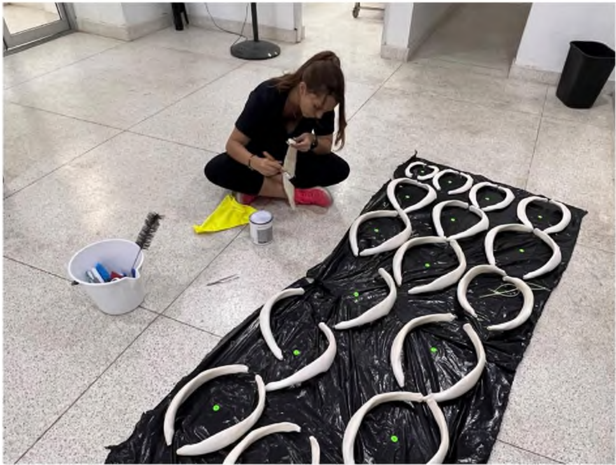
Figura 6. Colocación de la mezcla de glaze F-10 con aguarrás.
