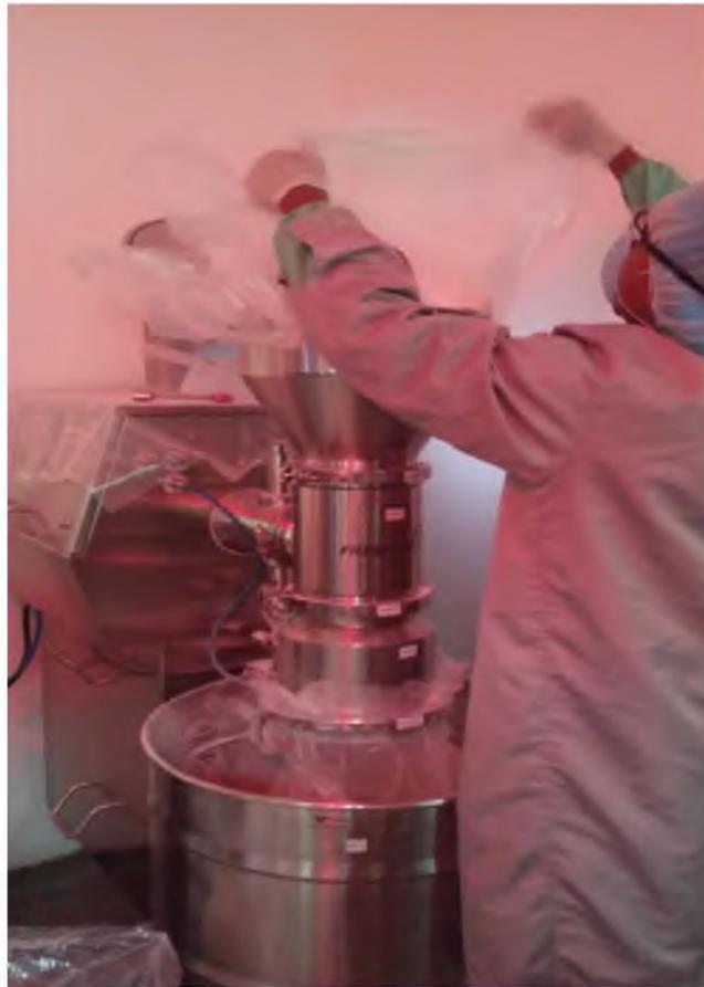
Ilustración 12, Operador realizando la operación granular por vía directa con el granulador cónico.
