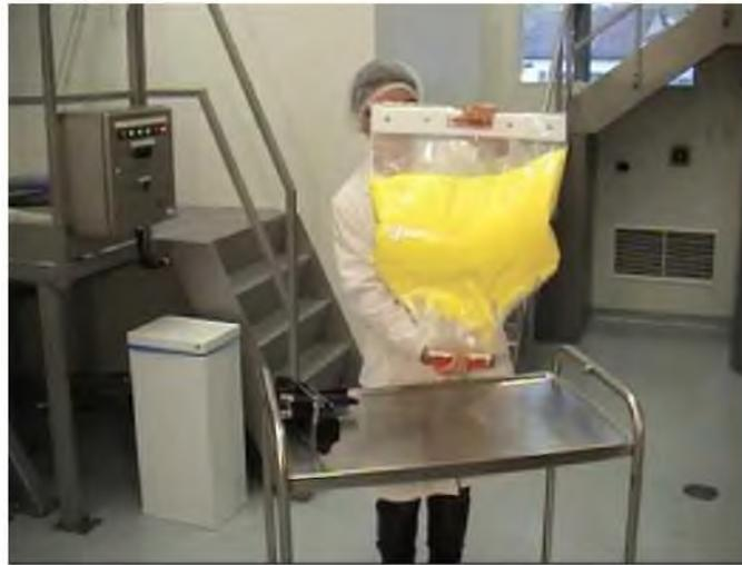
Ilustración 16, Sistema de contención desechable del producto.
