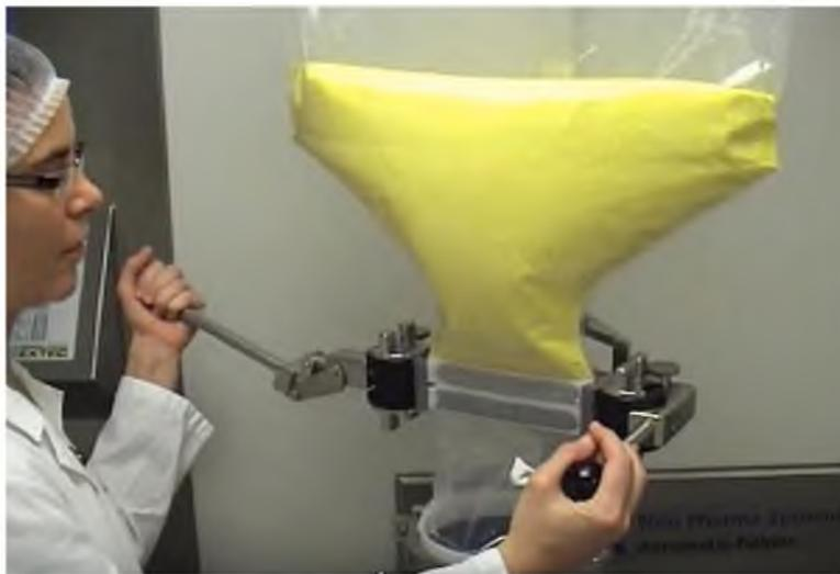
Ilustración 19, Acople del Hicoflex® Charge Bag con el granulador.
