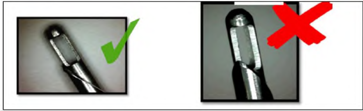
Figura 14. Acopladura correcta vs incorrecta
