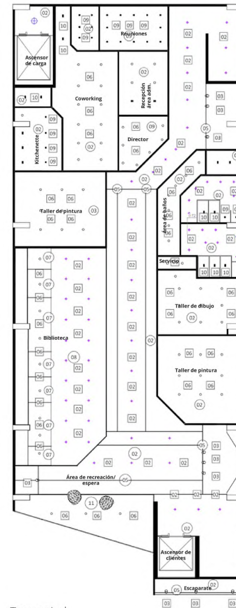
Tercer nivel Planta de techo y luminarias
