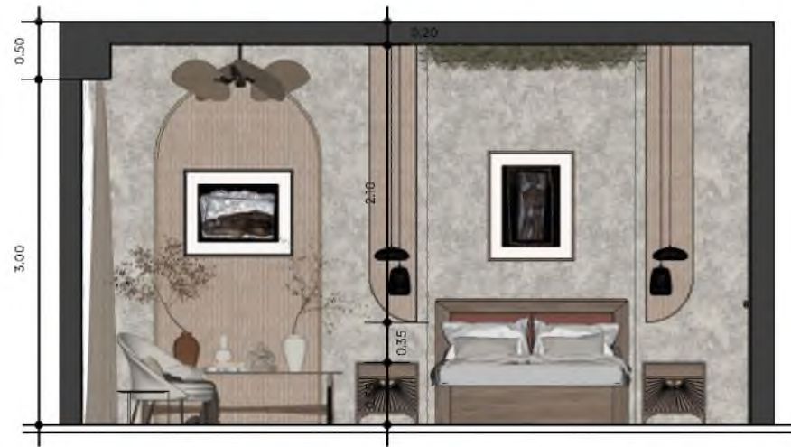
C ELEVACIÓN SECCIONADA HABITACIÓN SIMPLE
