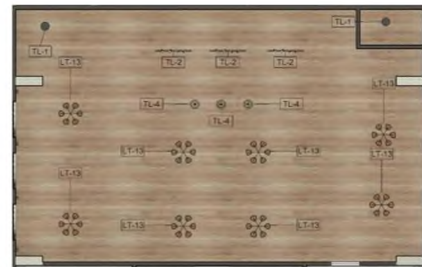
Planta de Plafones y luminarias
