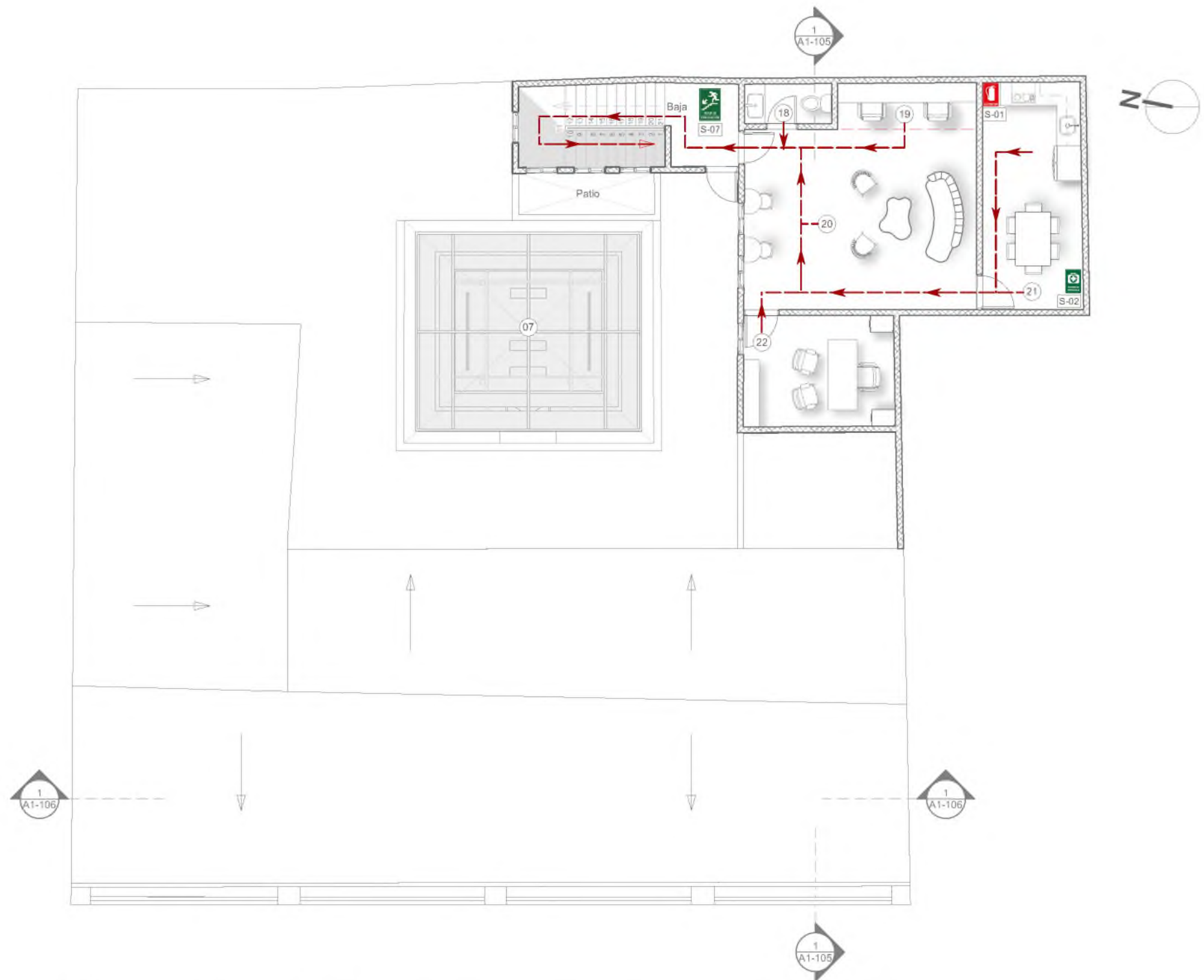
2 Planta de Evacuación y Señaléticas - Nivel 02
