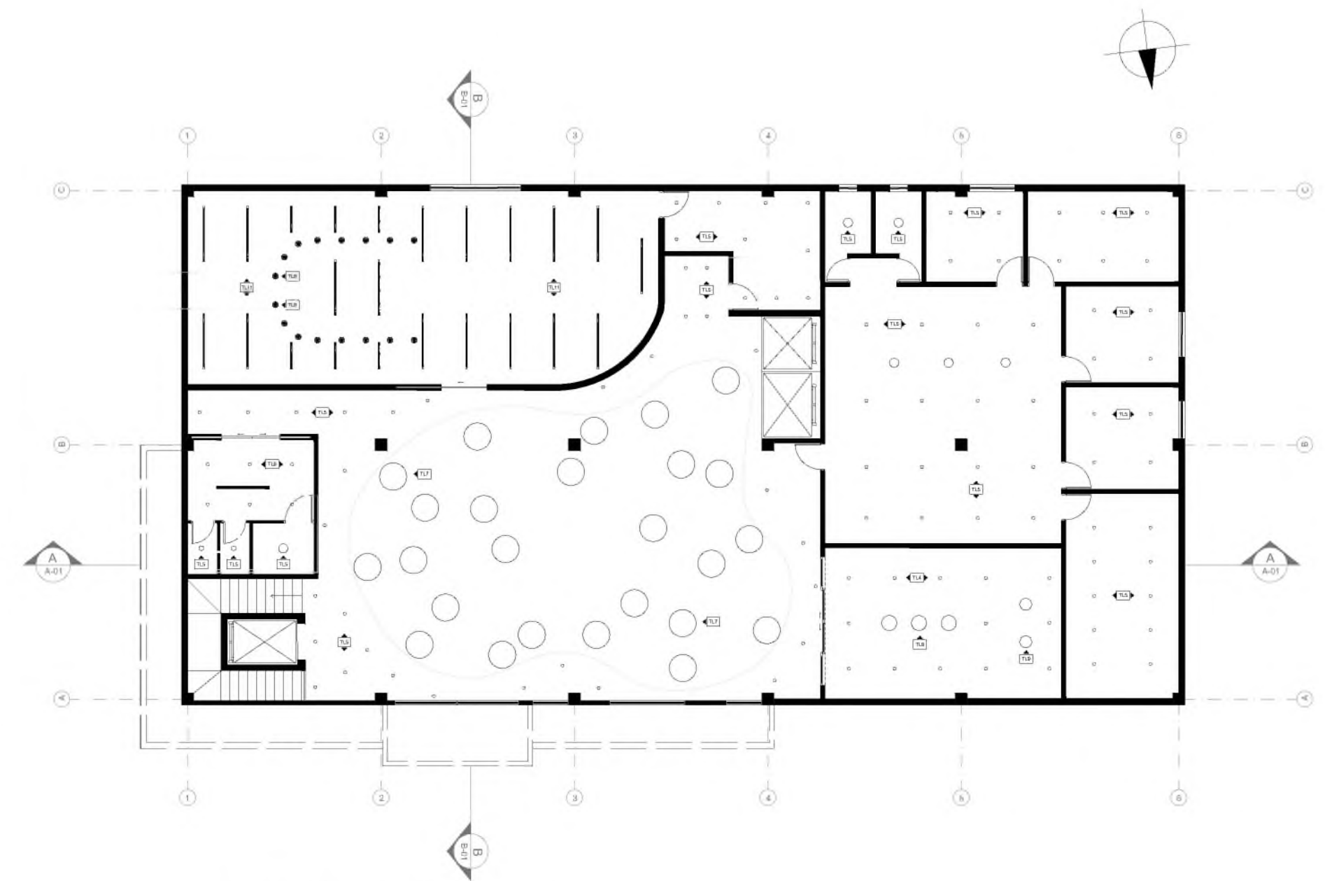
02 PLANTA DE LUMINARIAS 2DO NIVEL 1:175
