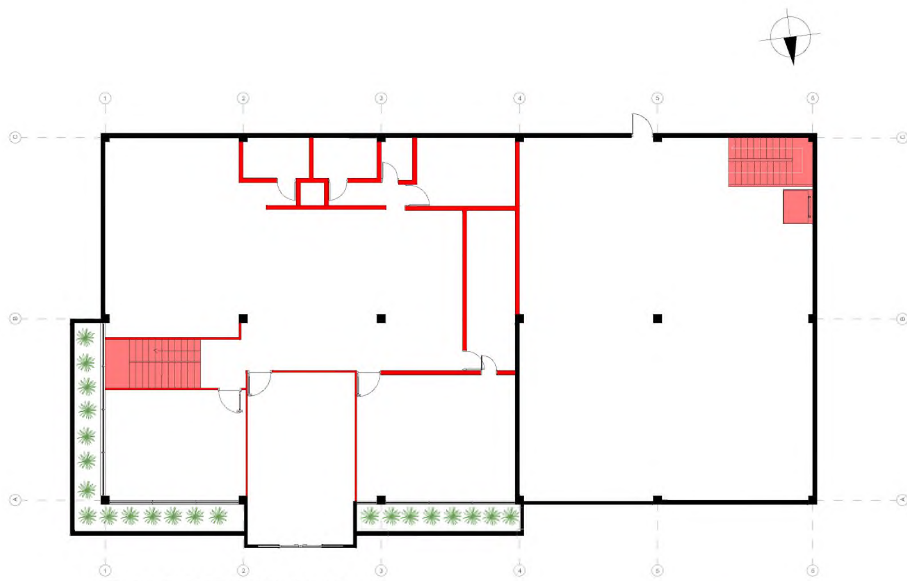
01 PLANTA DE DEMOLICIÓN 1ER NIVEL 1:175
