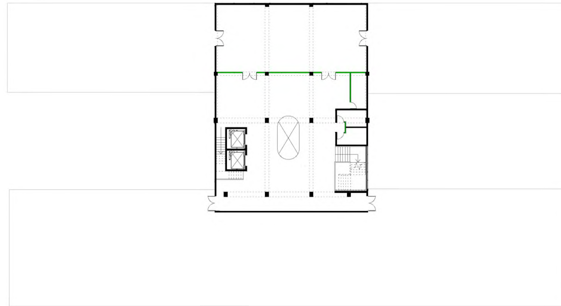
1 MUROS A CONSTRUIR SEGUNDO NIVEL
