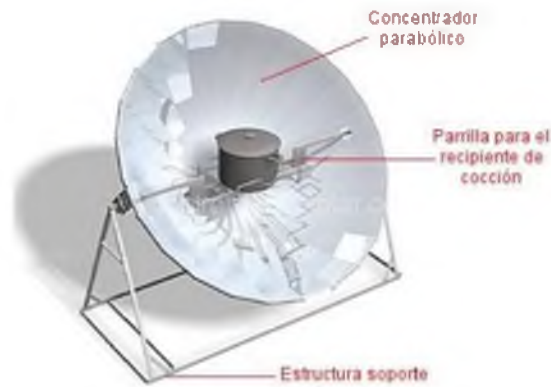
Figura 25. Partes de una cocina solar parabólica. Diseño de Dieter Seifert (Alemania). Fuente. Gastronomía Solar. 2018.
