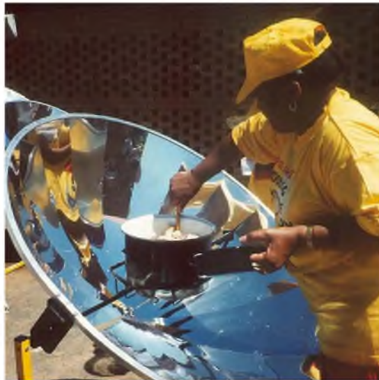
Figura 24. Cocina solar parabólica o de concentración. Fuente: Ecocosas. 2012.
