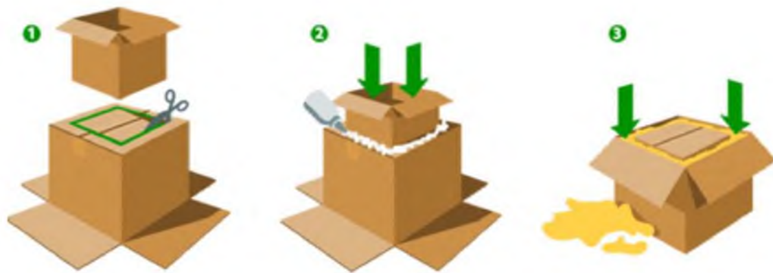
Figura 32. Este esquema muestra cómo construir el horno solar con dos cajas de cartón separadas por una capa de material aislante. Fuente: Terra Ecología Práctica. 2010.
