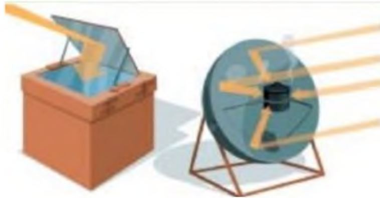
Figura 21. Captación de calor solar por acumulación en un horno solar y de concentración en una parábola. Fuente: Perspectiva Ambiental. Grupo Terra. 2002.
