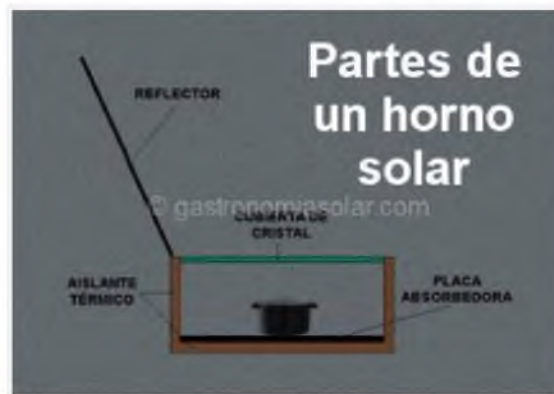
Figura 31. Partes básicas de un horno solar. Fuente: Gastronomía Solar. 2018.
