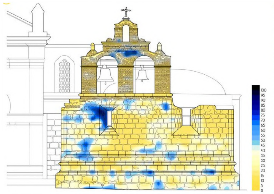
Figura 4: Cartografía de humedad en el campanario
