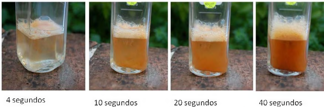
Figura 6: Análisis mediante reacción química de la piedra coralina.
