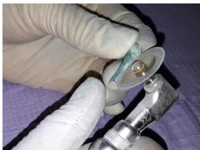
Figura 18. Corte de muestras con disco diamantado. Fuente propia del autor.
