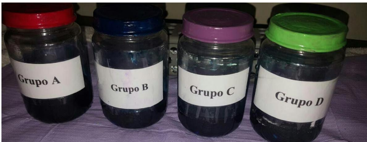
Figura 17. Muestras sumergidas en azul de metileno al 0.2%. Fuente propia del autor.
