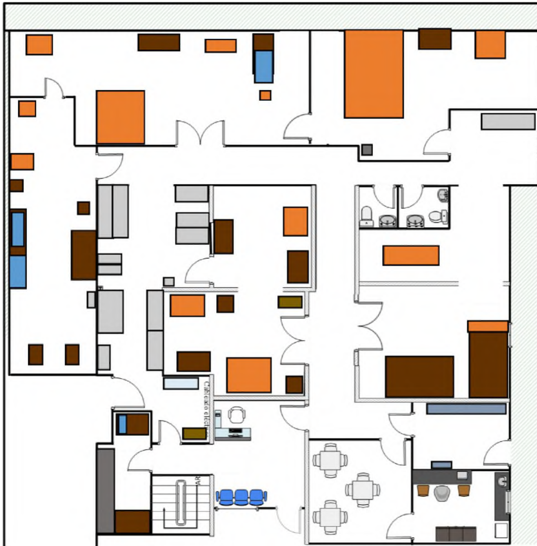
Ilustración 27. Distribución Propuesta de Maquinaria para el Área de Producción en la Primera Planta
