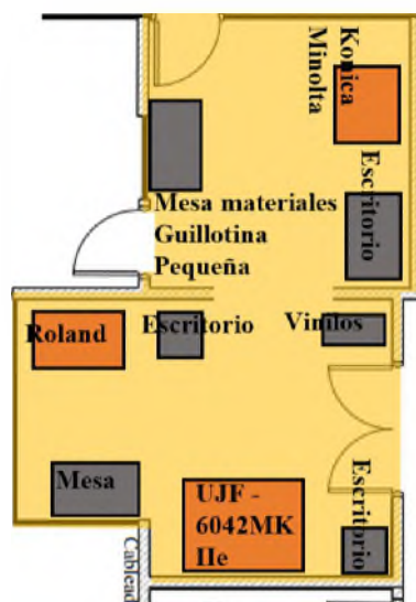
Ilustración 20. Distribución de Maquinaria Propuesta para el Área de Impresión
