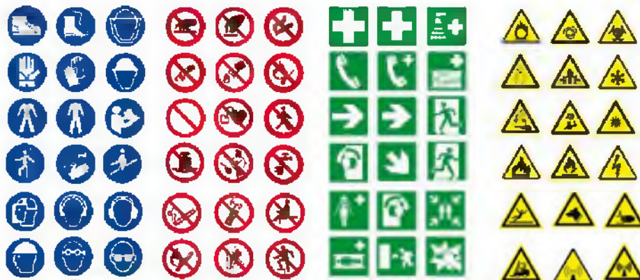
Ilustración 33. Señalizaciones y Símbolos de Seguridad Industrial
