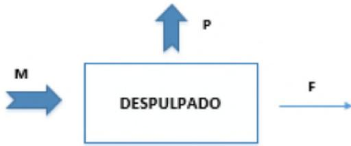
*Ilustración 6 balance de masa en el proceso del despulpado*
