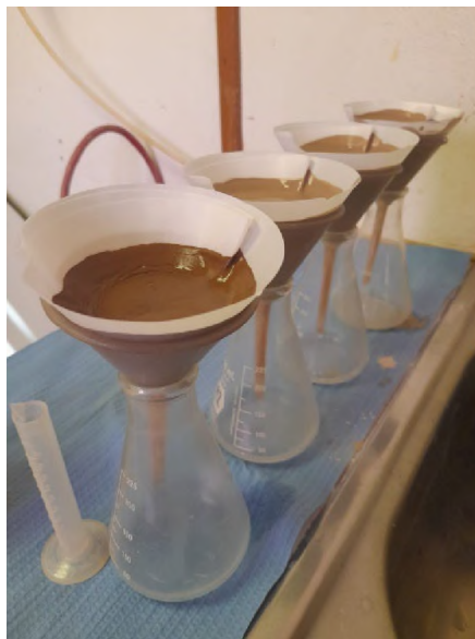
Figura 8. Filtrado de muestras de slurry cianurado.
