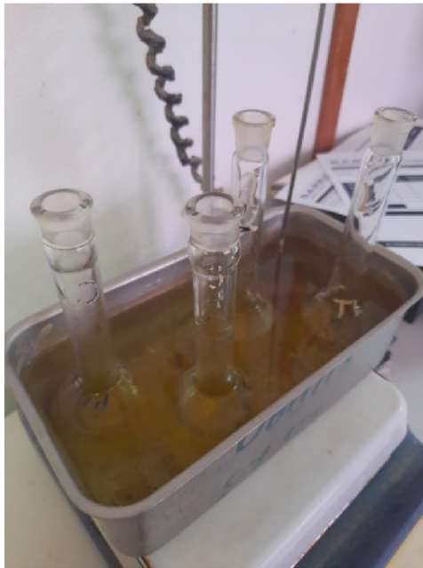
Figura 9. Calentamiento de solución filtrada con ácido pícrico.
