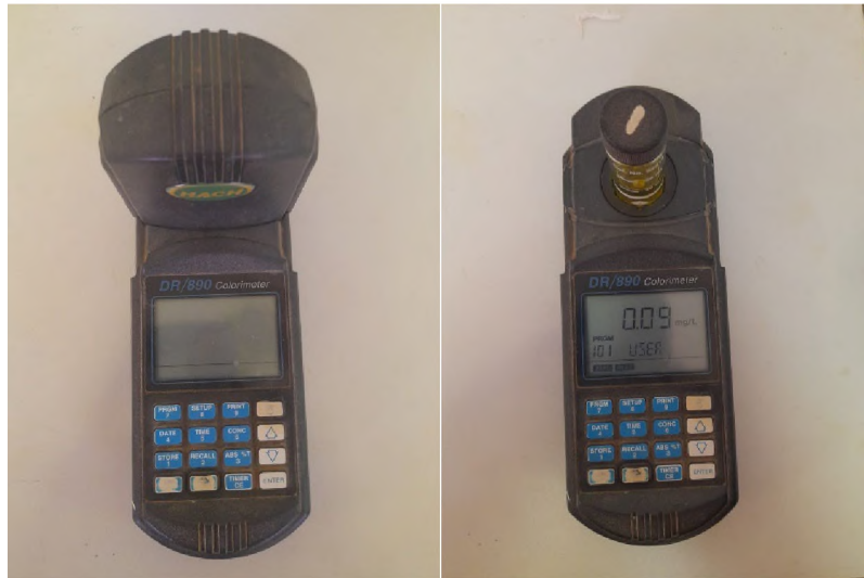
Figura 7. Colorímetro DR/890 HACH utilizado para la medición de cianuro WAD en muestras.
