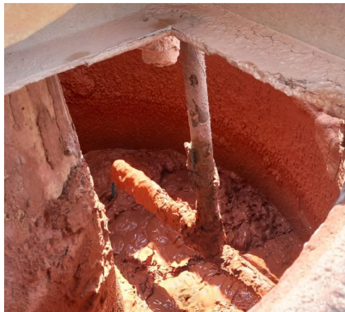
Figura 12. Adición de solución de \text{CuSO}_4 \cdot 5\text{H}_2\text{O} en tanque distribuidor.
