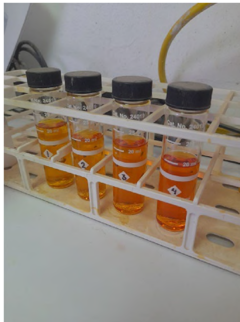
Figura 10. Estándares cianurados para calibración de colorímetro.
