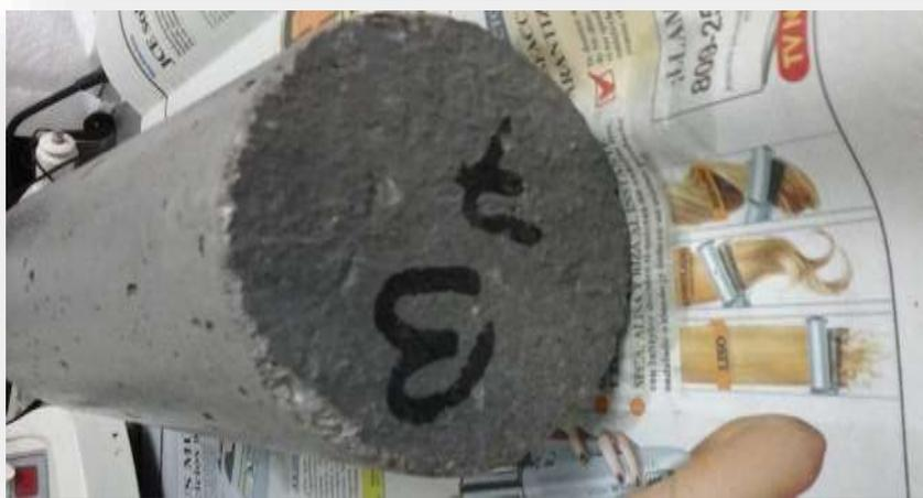
Ilustración 10. Probeta de Hormigón con Microsílíce
