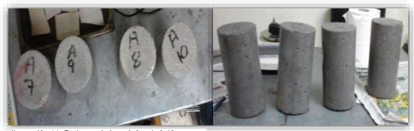
Ilustración 11. Probetas de hormigón a/c 0.40
