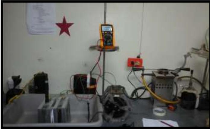
Ilustración 20. Equipo utilizado para el ensayo RCPT
