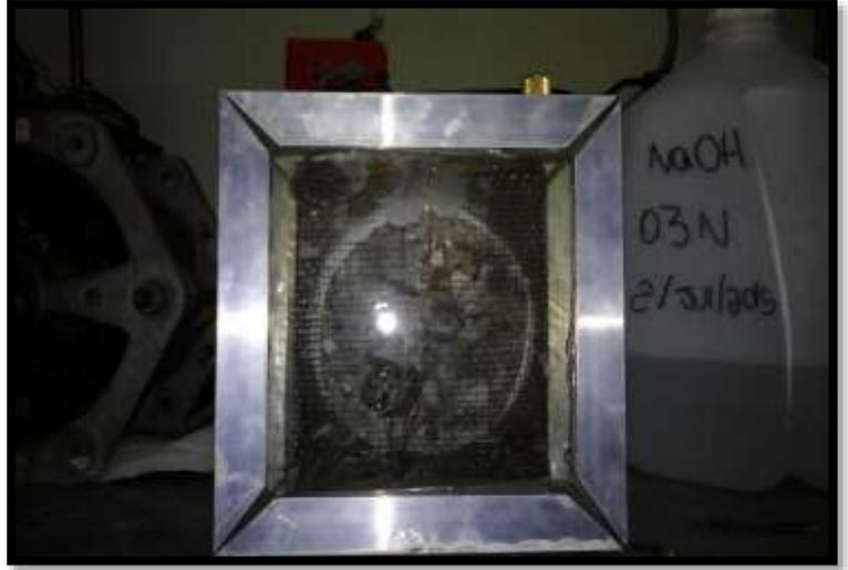
Ilustración 22. Celda contenedora de las soluciones
