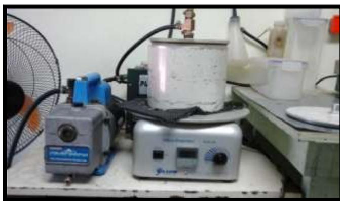
**Ilustración 8.** Bomba y Desecador de vacío para desairar las muestras
