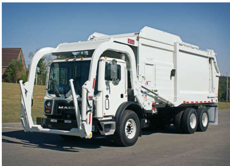
Ilustración 4: Vehículo Recolector con mecanismo de carga frontal
