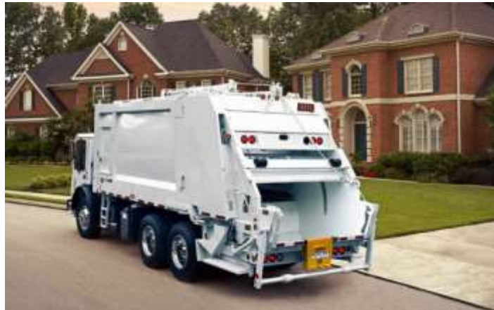
Ilustración 6: Vehículo Recolector de carga trasera con mecanismo de compactación
