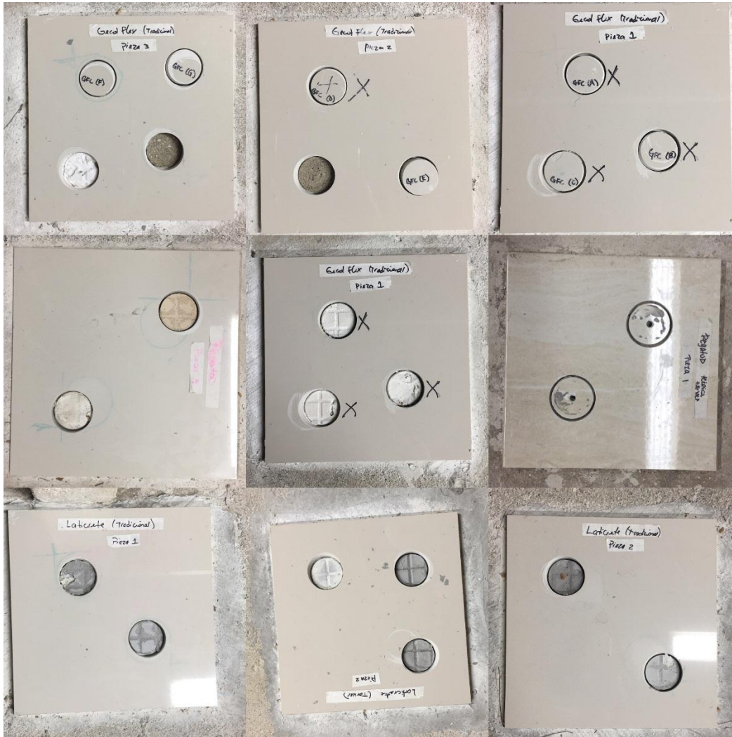
Ilustración 13 Muestras que fallaron.
