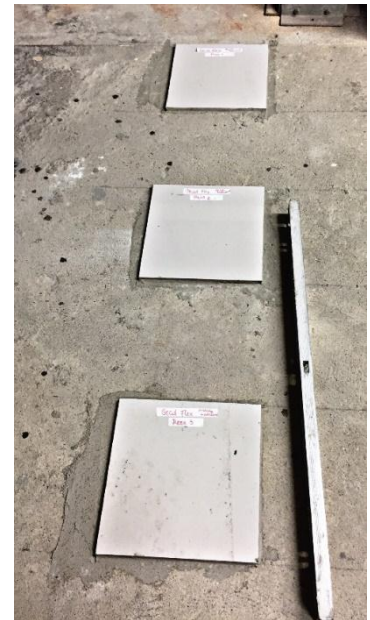
Piezas 1, 2 y 3 Técnica "Casera" en conjunto. ADHESIVO A
