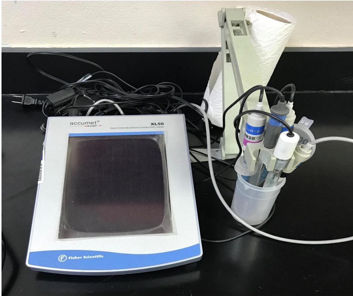
*PH-metro y conductímetro. Instrumento utilizado para medir el PH y conductividad eléctrica*
