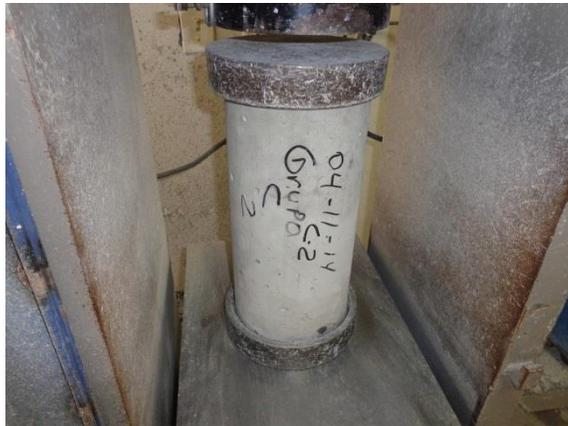
*Ilustración 1: "Prueba a compresión de probeta cilíndrica de concreto"*
