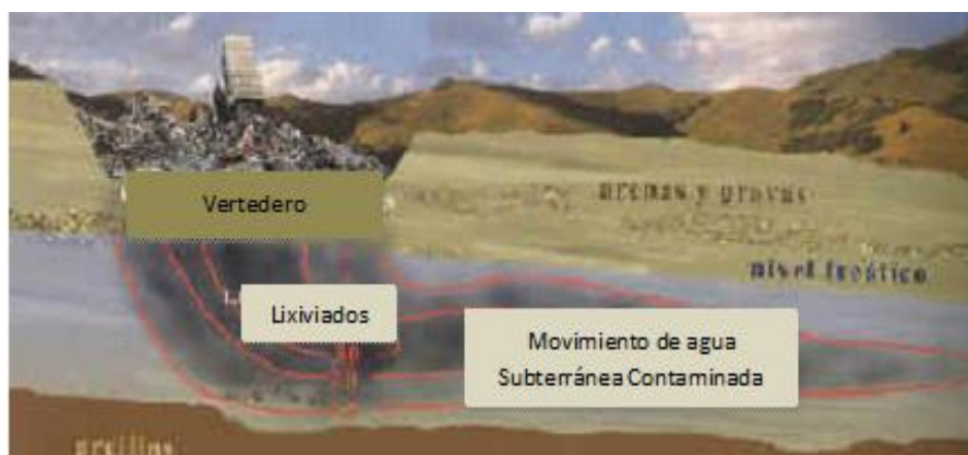
Figura 6.11 Contaminación de aguas subterráneas causados por los lixiviados
