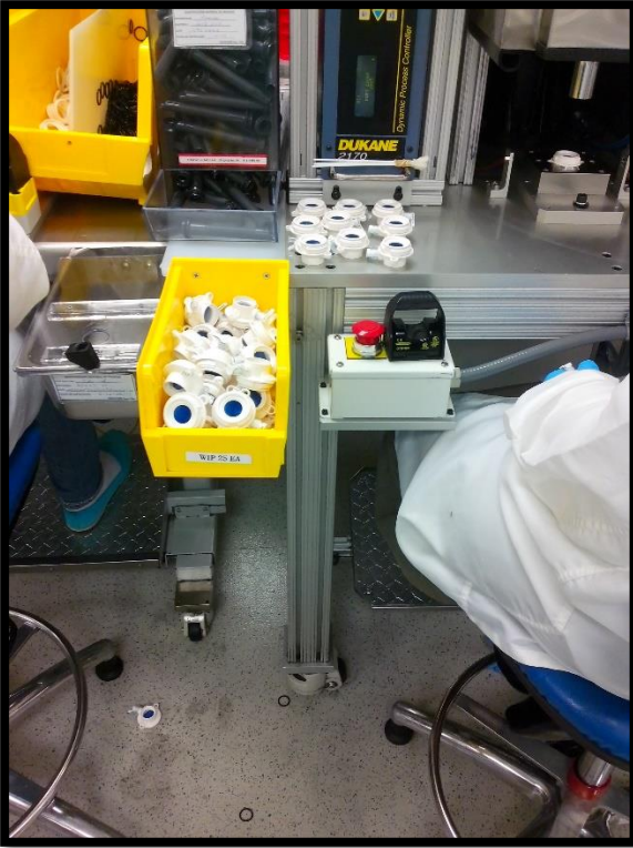
Figura (10). Estación de ensamble válvula de aire línea Versaport.
