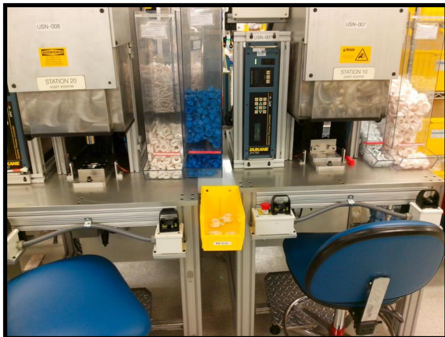
Figura (15). Estación #1. Ensamble válvula de aire y cuerpo plástico. Estación #2. Ensamble de sello plástico.
