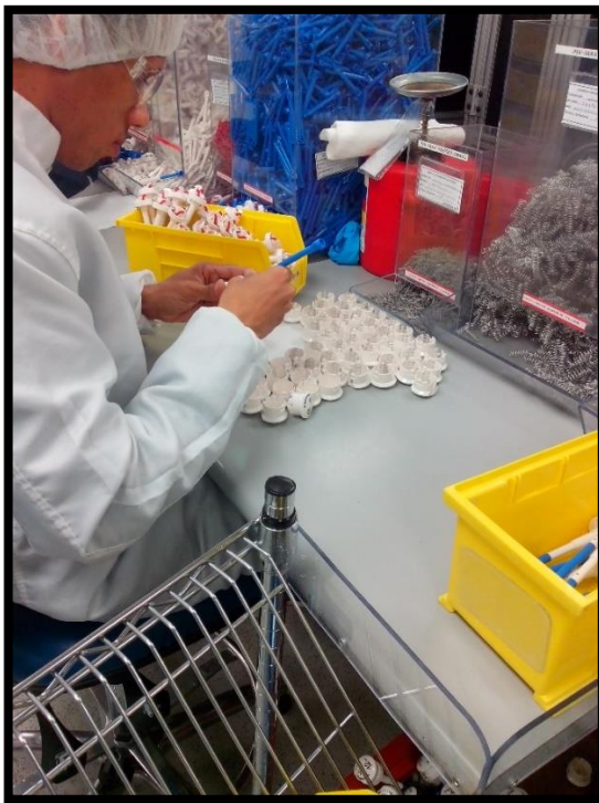
Figura (8). Estación de ensamble de cuchilla línea Versaport.
