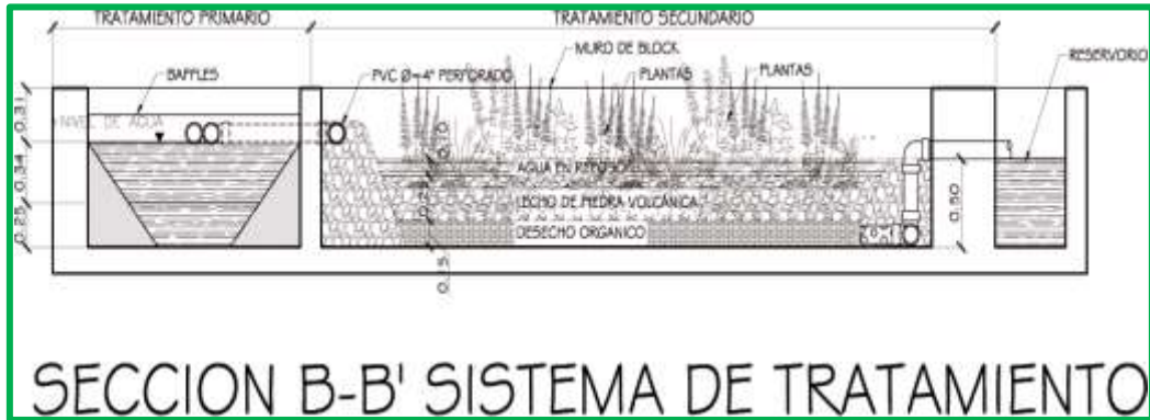
Ilustración 11. Sección transversal del sistema de humedal artificial
